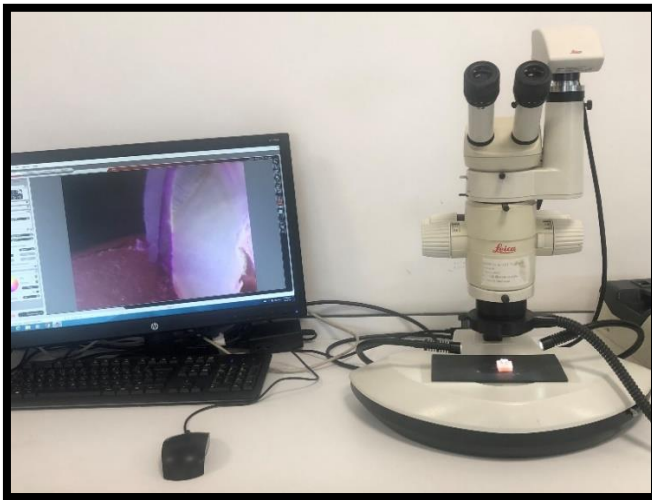
Resim 3.16. Çalışmada kullanılan stereomikroskop (Leica MZ12 Stereomicroscope, Almanya)
