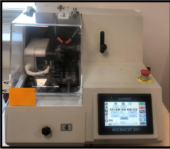
Resim 3.14. Çalışmada kullanılan mikrocut cihazı (Micracut 201, Metkon Instruments Ltd, Bursa, Türkiye)
