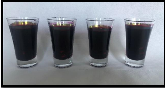
Resim 3.12. %2'lik bazik fuksin solüsyonunda bekletilen örnekler
