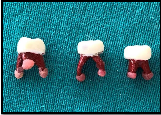
Resim 3.11. Tırnak cilası uygulanmış ve apikal forameni mum ile örtülmüş örnekler
