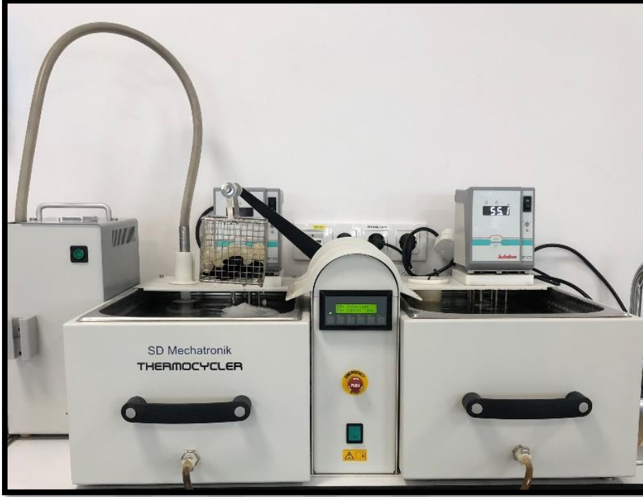
Resim 3.7. Çalışmada kullanılan termal siklus cihazı (SD Mechatronik Thermocycler, Almanya)
