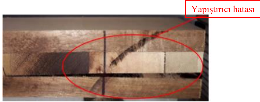
Şekil 14. CLT malzemede görülen yapıştırıcı hatası (Mohd Yusof vd., 2019)
