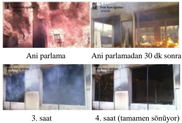
Şekil 24. Yangın deneyinden fotoğraflar (Brandon vd., 2021)
