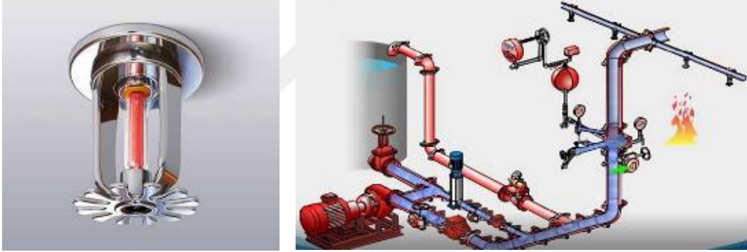
Şekil 21. Sprinkler başlığı ve çalışma sistemi (URL-33 ve URL-34, 2021)
