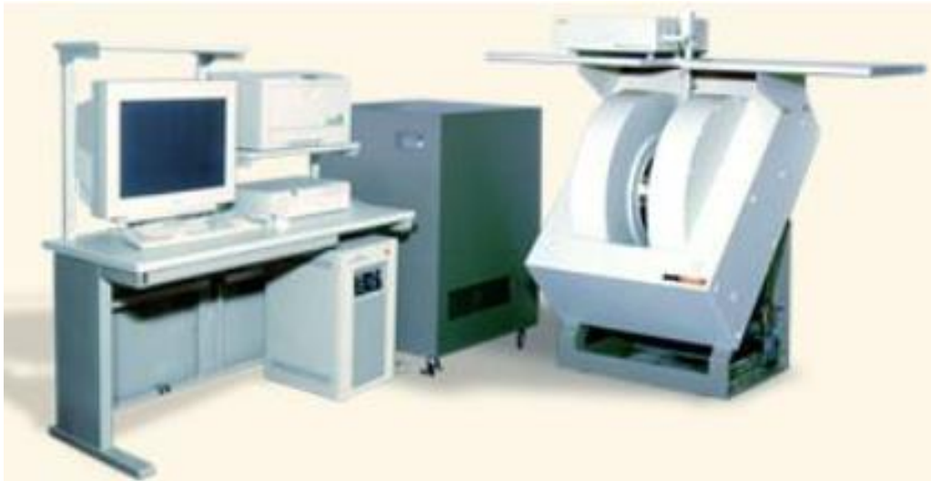
řekil 3.4. FMR cihazı X BAND JEOL-JES-FA300 Elektron Spin Rezonans Spektrometresi.
