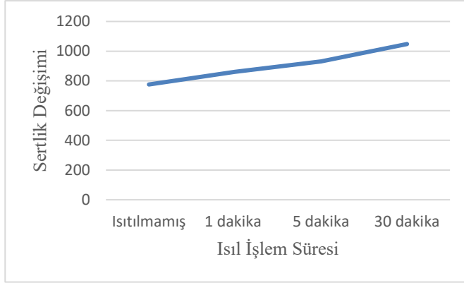
Şekil 4.14. \text{Fe}_{39}\text{Ni}_{39}\text{Mo}_4\text{Si}_6\text{B}_{12} metalik camın Sertlik Değişimi-Isıl İşlem Süresi.
