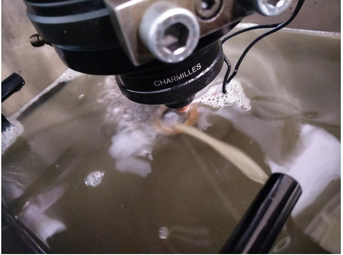
Şekil 5.4. Toz katkılı elektro erozyon tezgahı görüntüsü (İş parçası bağlı işleme yapılırken).
