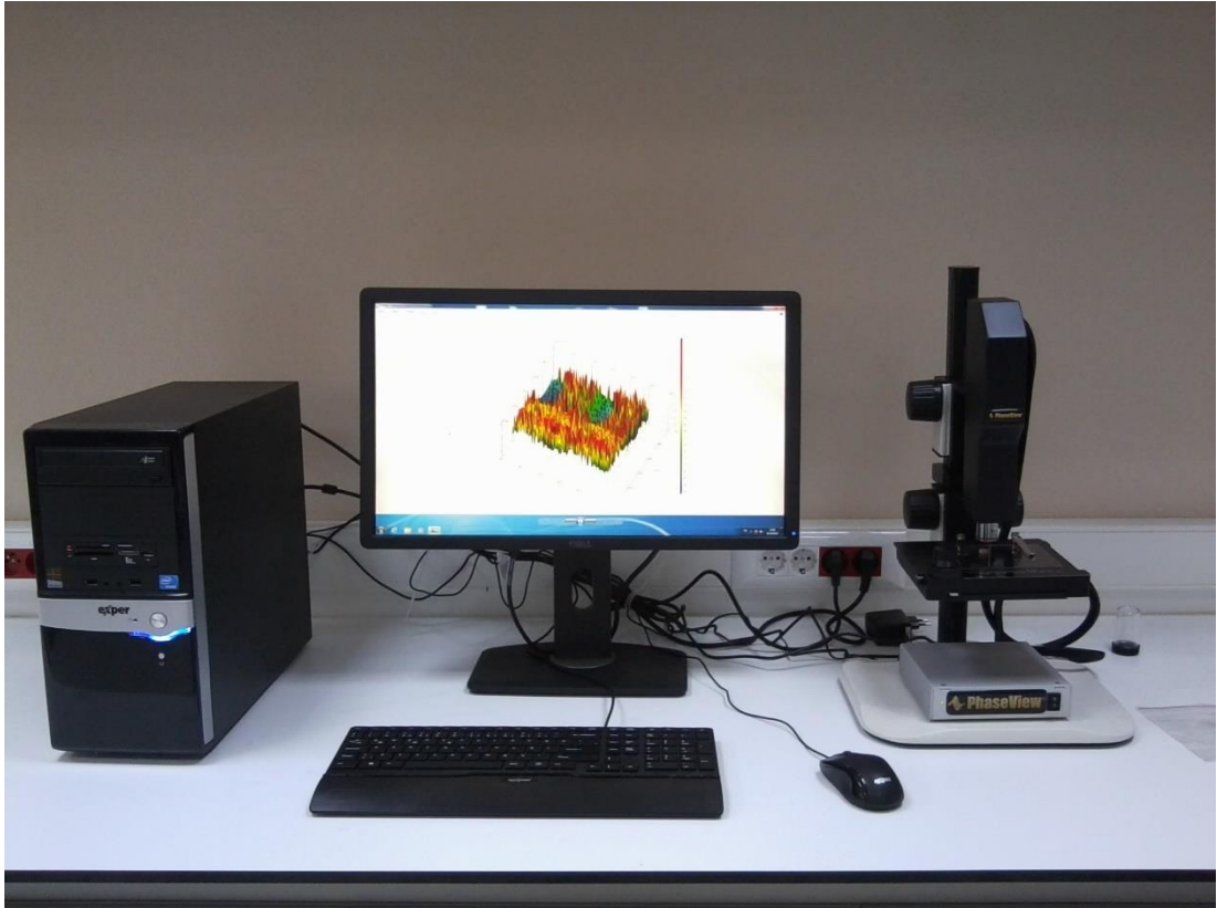
Şekil 5.5. Ortalama yüzey pürüzlülüğü ve yüzey topoğrafya ölçüm cihazı [84].
