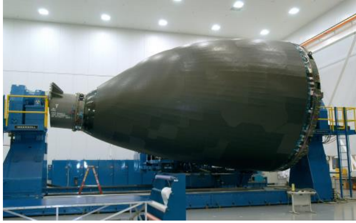
Şekil 5. AFP ile üretilen Boeing 787 gövde bölümü ve burun konisi (Chen vd., 2023)
