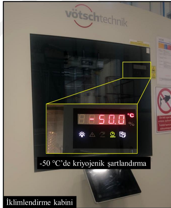
Şekil 11. CF/PEKK numunelerin iklimlendirme kabiniinde kriyojenik şartlandırılması
