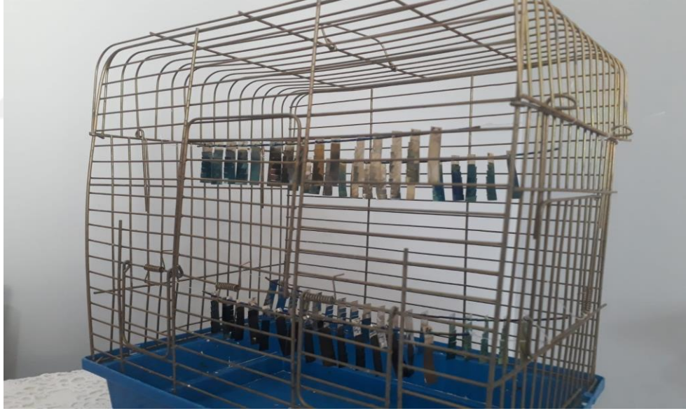
Şekil 3.1. Kuponların denizde bekletilmesinde kullanılan kafes sistemi
