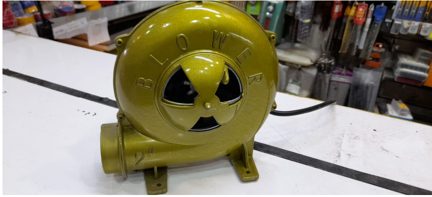
Figure 3.34. Centrifugal fan blower
