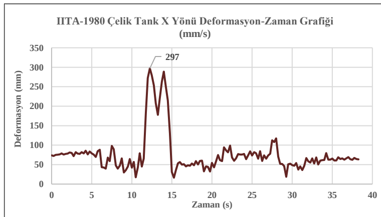
Şekil C4.61: Çelik tank duvar yanal deplasman analiz grafiği
