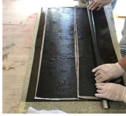
Şekil 3.3. Deney numunelerine ait sarma işlemi.
