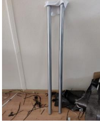
Şekil 3.2. Kalıp ayırıcı uygulaması yapılan alüminyum borular
