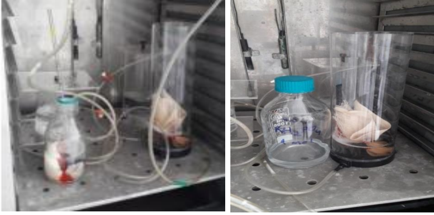
Şekil 3.1. Priming uygulamalarında kullanılan havalandırmalı uygulama kabı (bubble column) yöntemi.
