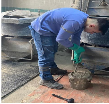
Şekil 1.13 Beton şişleme işlemi.
