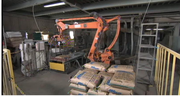
Şekil 6.1 Aktarma birimindeki istifleme işlemi için önerilen bir manipülatör.
