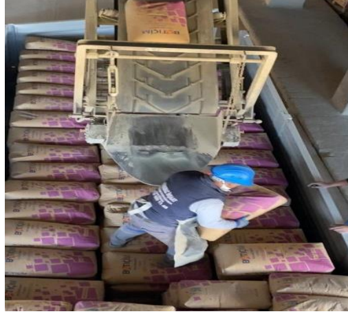
Şekil 1.12 Çimento torbalarının kamyonu istifi işlemi.
