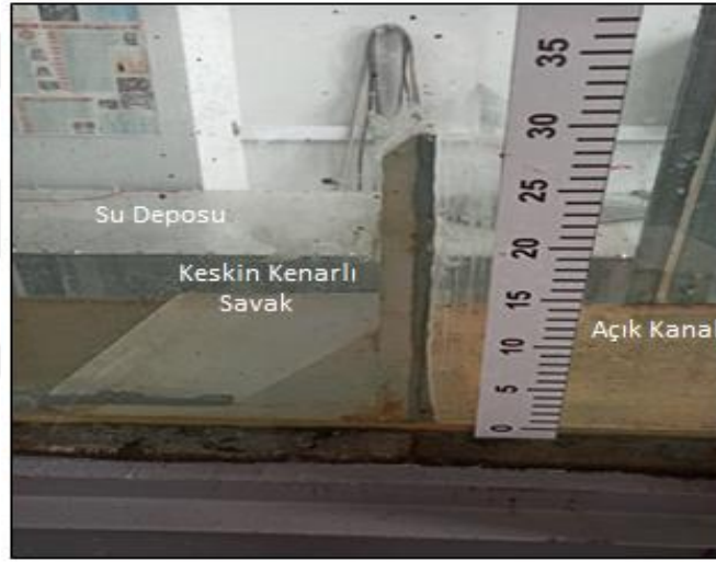
Şekil 2.3. Hacimsel yöntemde debi hesabı için açık kanal içerisine yerleştirilen keskin kenarlı savak.
