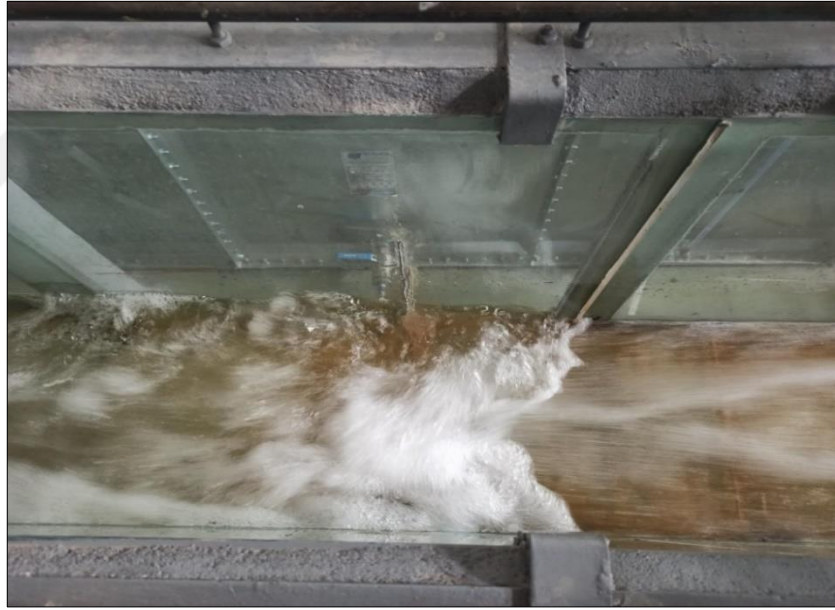
Şekil 2.12. Bir hidrolik sıçrama olayı esansında oluşan türbülans hareketi.
