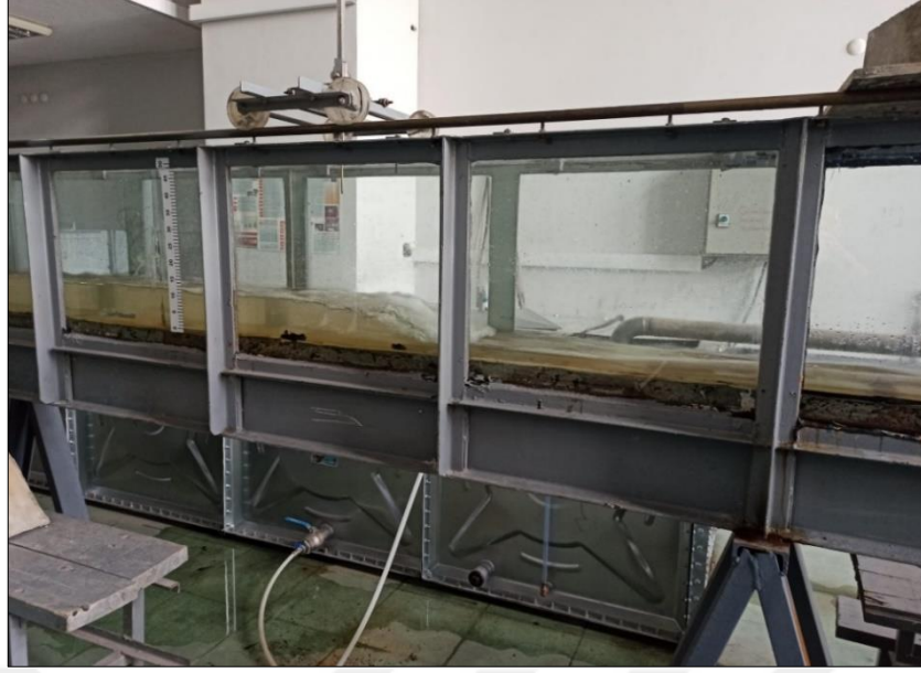
Şekil 2.11. Laboratuvar ortamında gözlenen tipik bir hidrolik sıçrama olayı.
