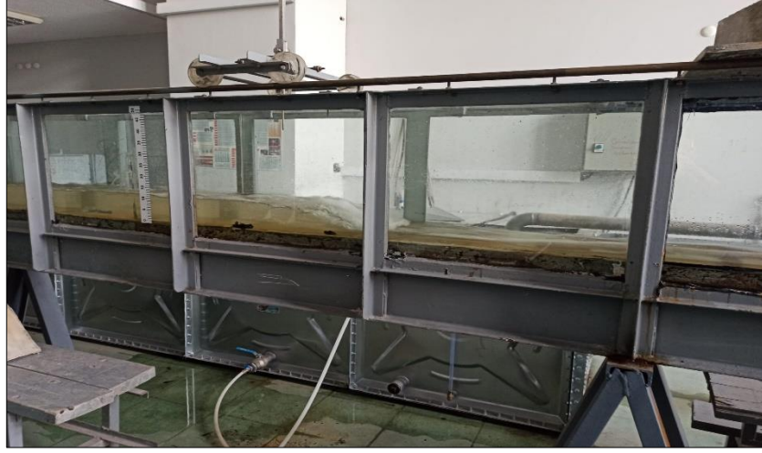
Şekil 3.5. Durum 2 için gözlenen hidrolik sıçrama sonrası su yüzeyi profili görüntüsü.
