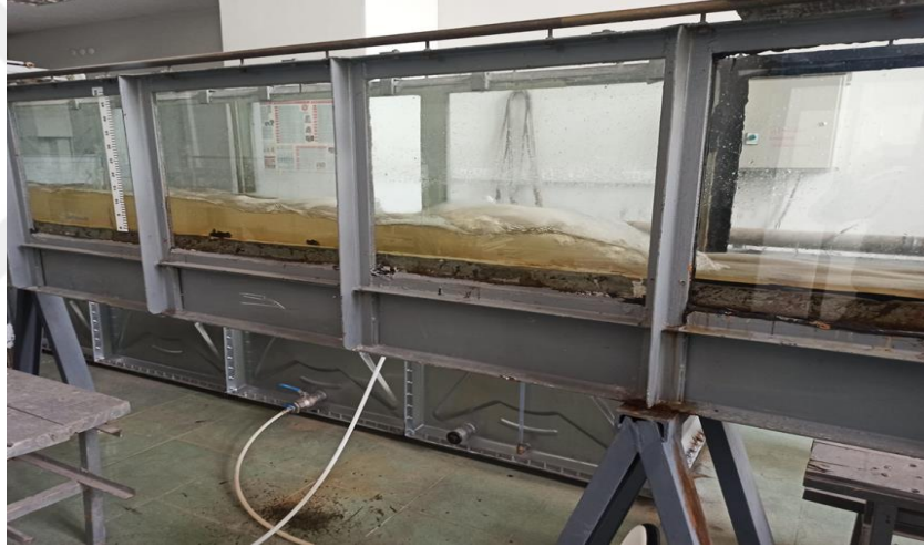
Şekil 3.6. Durum 3 için gözlenen hidrolik sıçrama sonrası su yüzeyi profili görüntüsü.
