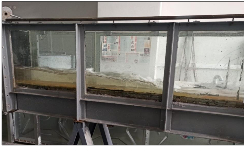
Şekil 3.4. Durum 1 için gözlenen hidrolik sıçrama sonrası su yüzeyi profili görüntüsü.
