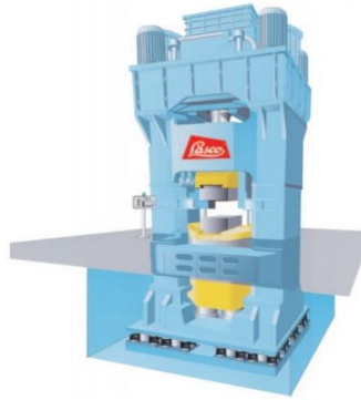
Şekil 2.20 Karşı Vuruşlu Çekiç
