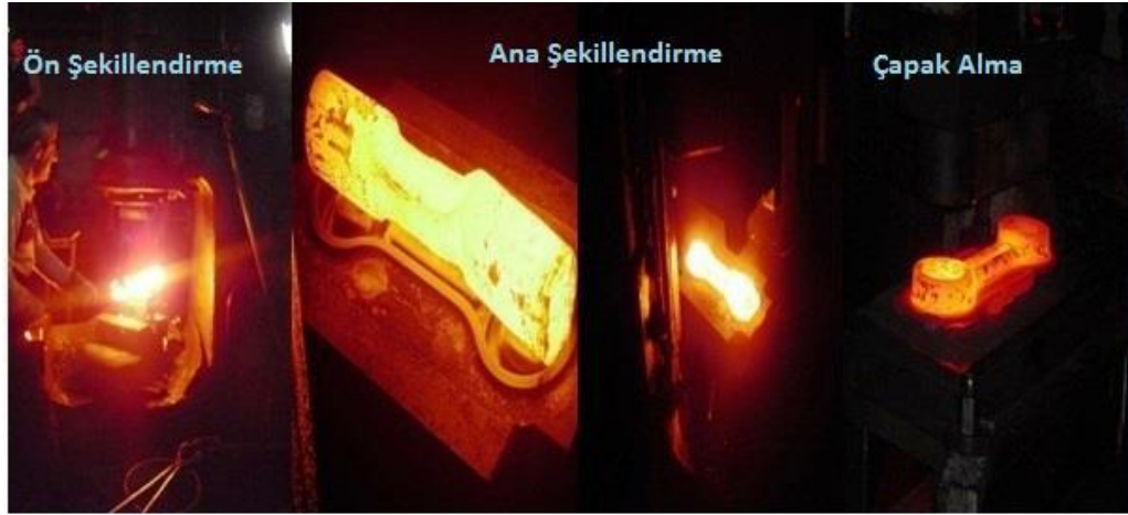
Şekil 2.17 Kapalı Kalıpta Sıcak Dövme
