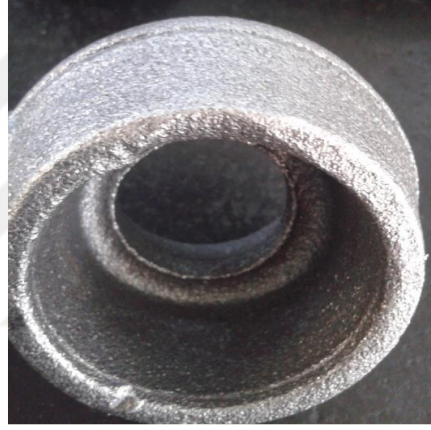
řekil 2.13 Kalıbın Dolmaması Kaynaklı Sorun
