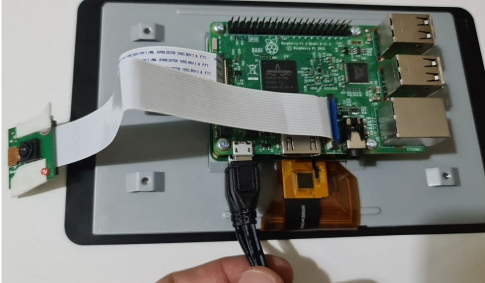
Şekil 14. Raspberry Pi ve LCD ekranın güç bağlantısı
