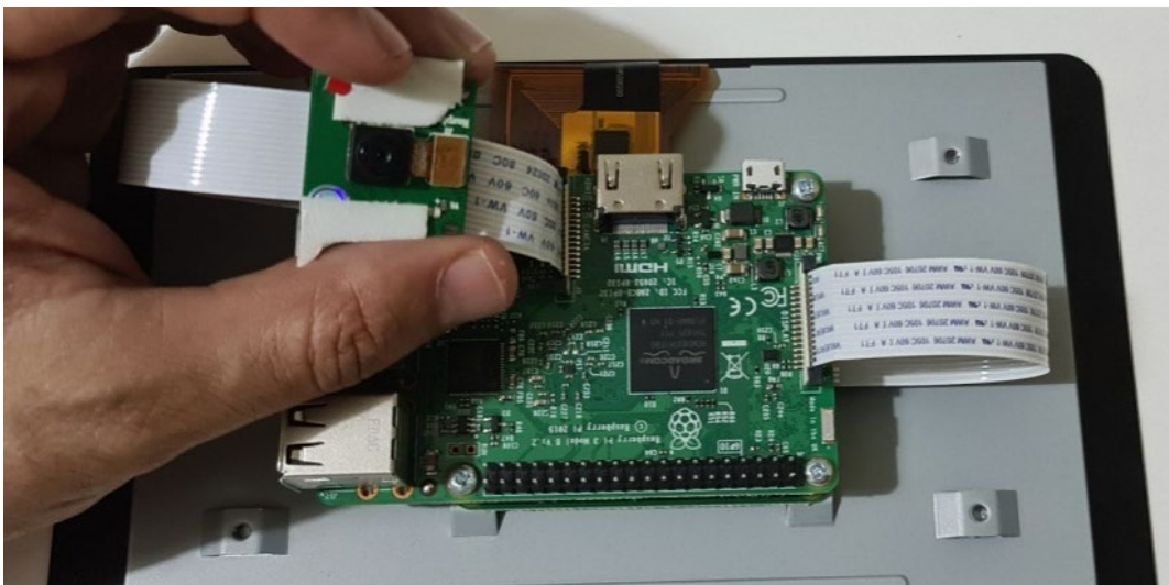
Şekil 13. Raspberry Pi'ye Raspberry Pi Kamerasının bağlantısı
