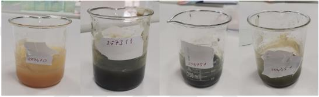
Fotoğraf 4.2 Serigrafi uygulaması için çözücülerini uzaklaştırılmış basınca duyarlı mürekkepler
