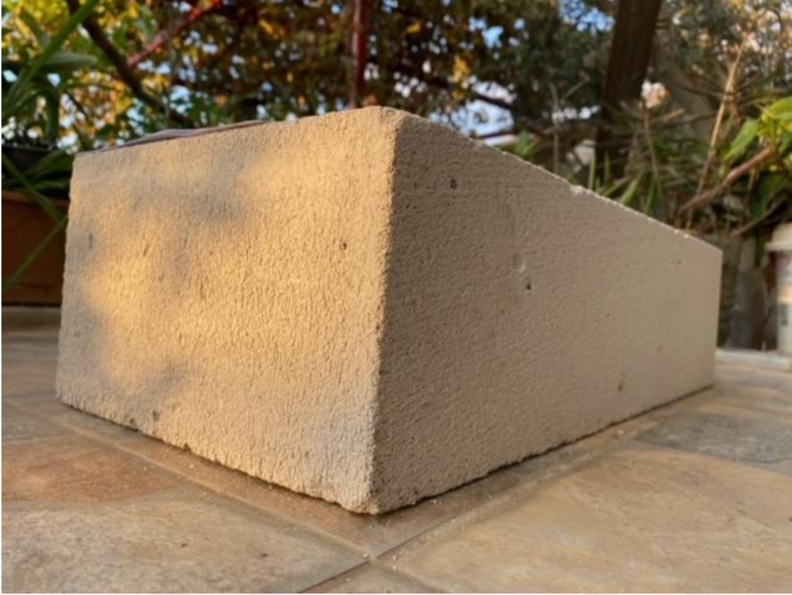
řekil 6: Gaz beton
