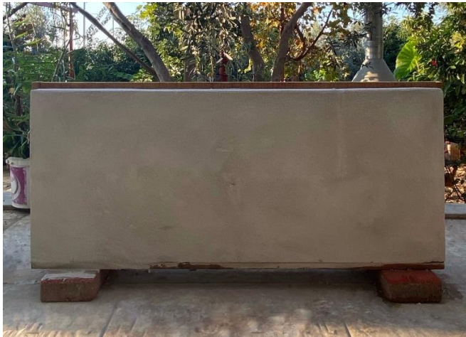
Şekil 12: Gaz betonlardan örülen hedef yüzey ve üzerinde iki kat sıva
