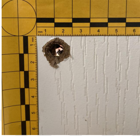
Şekil 19: 10m mesafeden 60° ilk açılı ile yapılan atıştan ahşap yüzeydeki çıkış deliği
