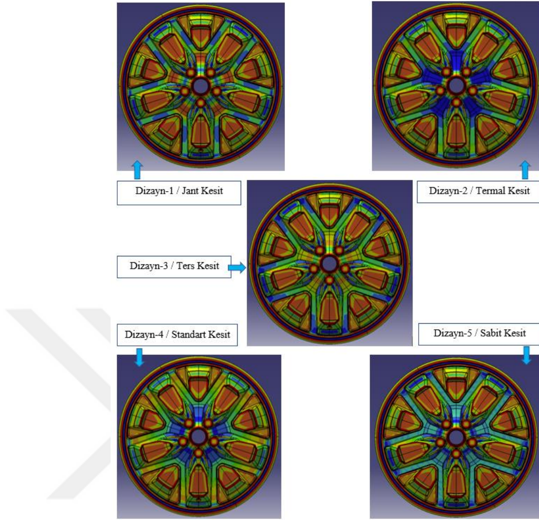
Şekil 4.2 Tüm Kalıp Alt Maça Kalınlık Varyasyon Görünümleri
