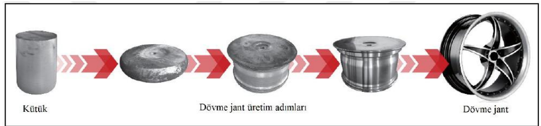
Şekil 2.5 Dövme jant üretim prosesi (Işık, 2019)
