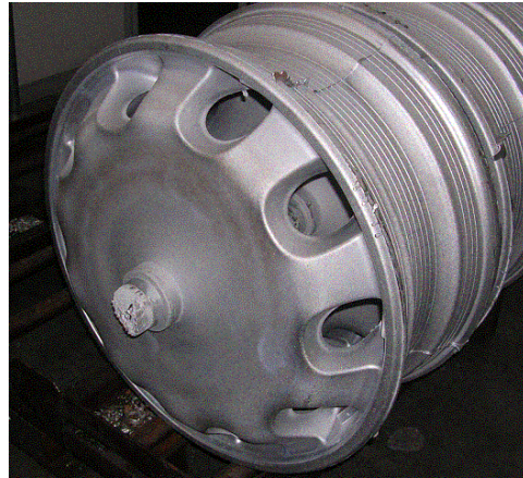
Şekil 2.10 Alçak basınç döküm tekniğiyle dökülmüş bir jant (Akıncı, 2005)
