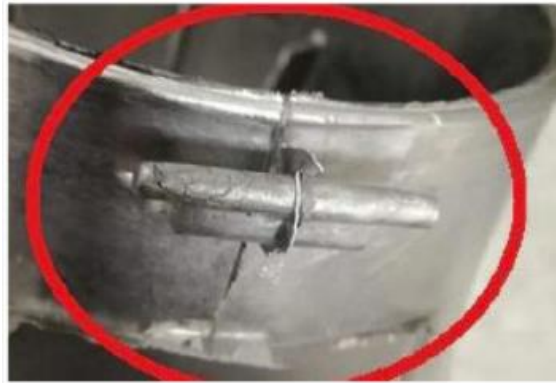
Şekil 2.13 Soğuk Birleşme Hatası Yaşanmış Parça (İştar vd., 2021)
