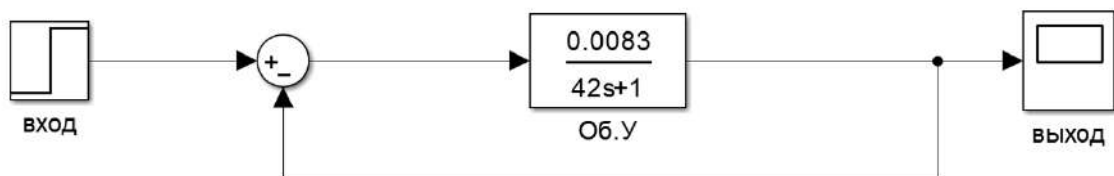
Рис.3.2 - Структурная схема системы управления, отвечающая за повышение/понижение давления в расширителях продувки ПГ
