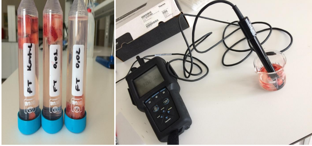
Şekil 3.11. Elektriksel iletkenlik analizi ölçüm öncesi ve kondaktvimetre ile ölçümü
