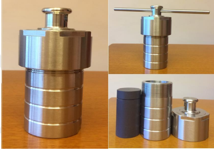
Şekil 3.1. MOÇ'ların sentezinde kullanılan reaktör
