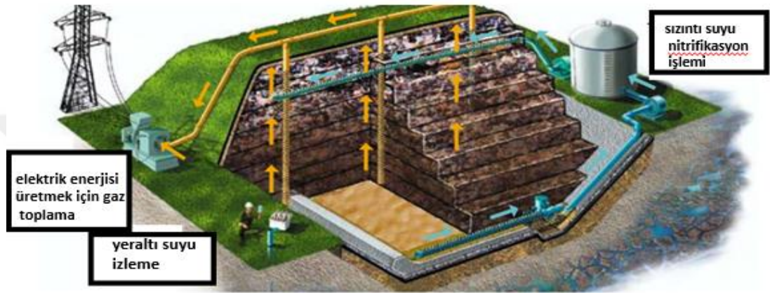
Şekil 2.6: Fakültatif biyoreaktör tasarımı
