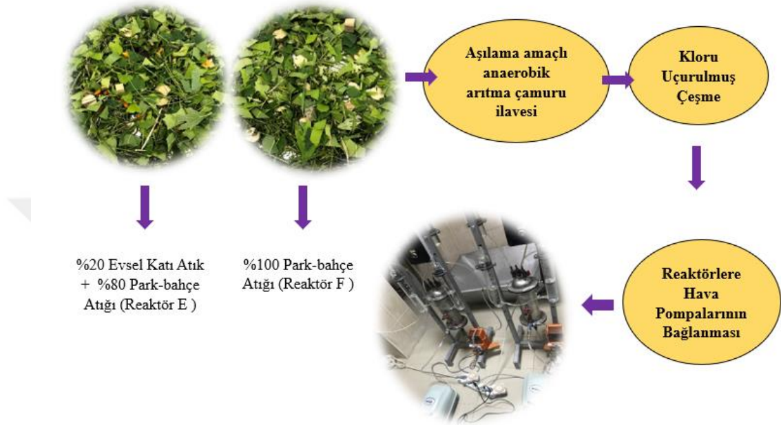
Şekil 3.7: Park-bahçe atıklarının semi-aerobik / anaerobik biyoreaktörlere yüklmesi
