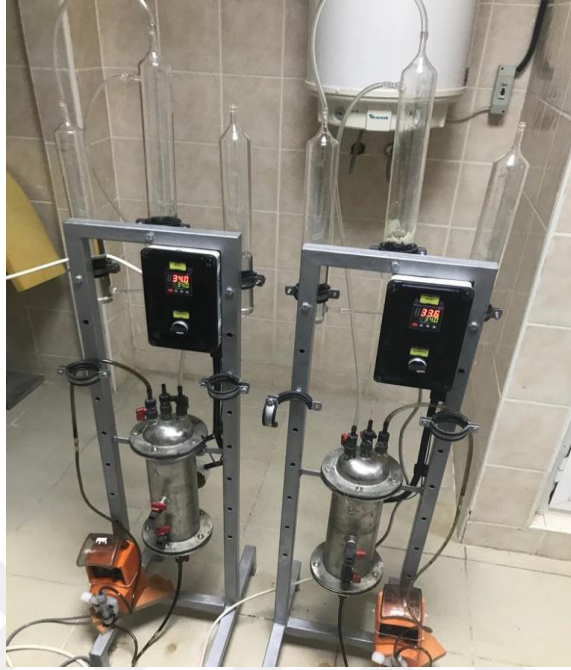
Şekil 3.2: Anaerobik biyoreaktörün çalışma sistemi
