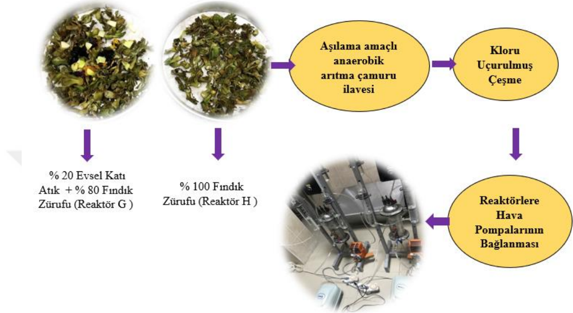
Şekil 3.8: Fındık zürufunun semi-aerobik / anaerobik biyoreaktörlere yükleneesi
