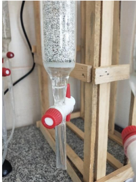
Şekil 2.2. Filtre kolonlarının çıkış vanaları ve tıkanma olmaması için yapılan por katman
