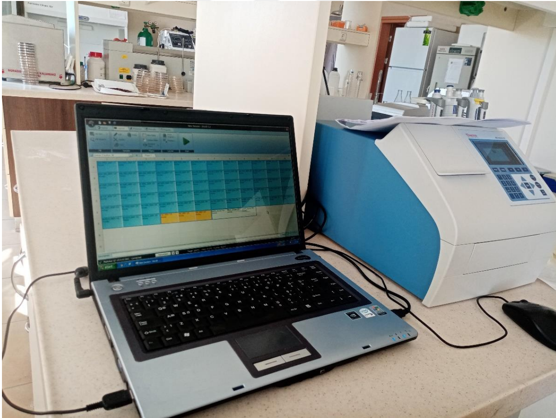
Şekil 3.3: Spektrofotometrik ölçümlerin gerçekleştirildiği mikrolaka okuyucu.
