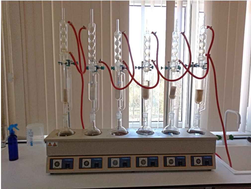
Şekil 3.1: Ekstraksiyon işleminin gerçekleştirildiği Soxhlet ekstraktörü.
