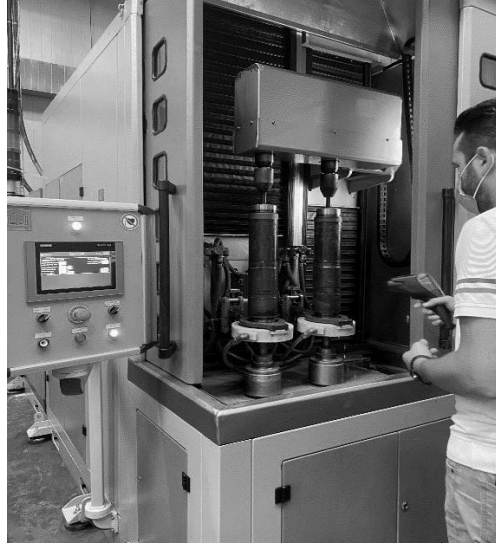
Şekil 6.16 Ürünlerin ve Soğutma Sıvısı Sıcaklık Ölçümü
