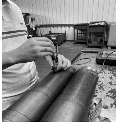
Şekil 6.13 İndüksiyon Olmuş Ürünlerin Sertlik Kontrolü
