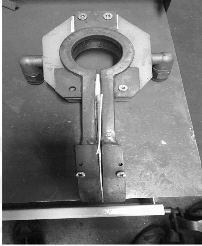
Şekil 6.2 Bobin ve Quench Bağlantı Gösterimi
