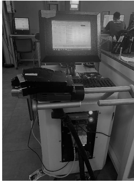
Şekil 6.7 HİTACHI PM-MASTER Pro2 Spektrometre Cihazı
