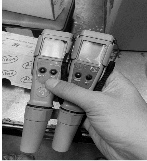
Şekil 6.20 İletkenlik ve Ph Değerlerinin Kontrolü
