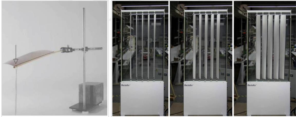
Resim 2.43. Çiçeklerin elastik yapısından yola çıkarak tasarlanmış fiziksel model ve cephe gölgeleme elemanı olarak üretilen prototip (Knippers ve Speck, 2012)
