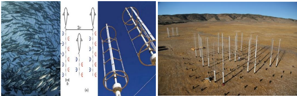
Resim 2.25. Balıklardan yola çıkılarak tasarlanan dikey eksenli rüzgâr türbini (URL-58)
