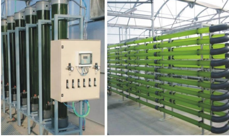
Resim 2.28. Endüstriyel mikroalg foto-biyoreaktörler, Alga Energy şirketi (Cervera Sardá ve Gómez Pioz, 2015)
