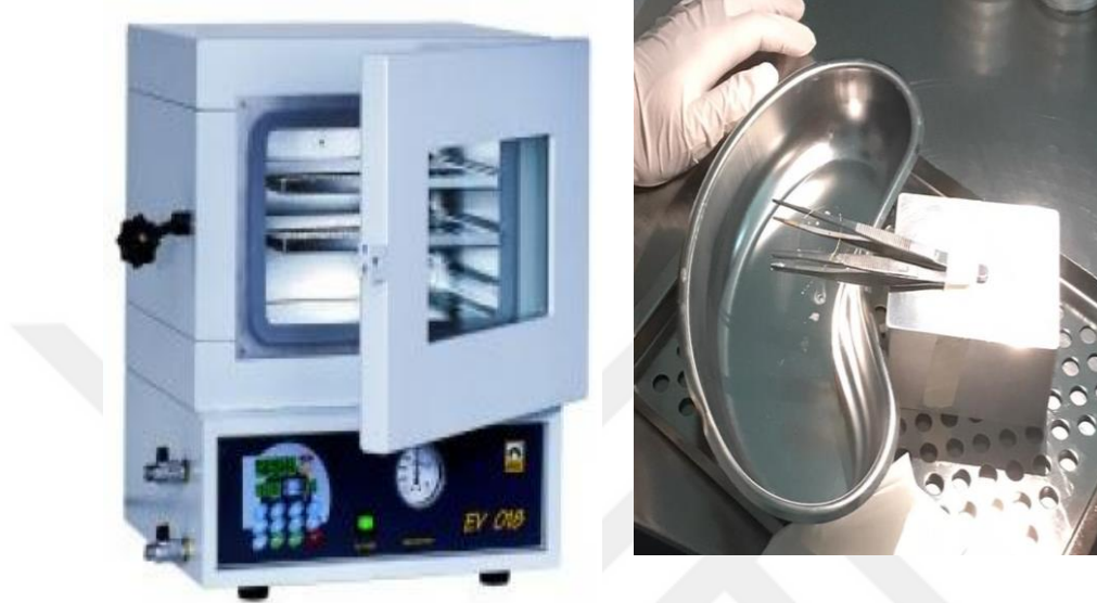
Şekil 14: KNT’lerin fırınlanması ve soğutulması
