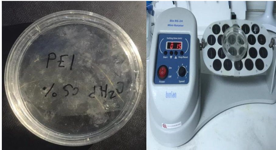
Şekil 13: Tungsten tellerin PEI ile kaplanması
