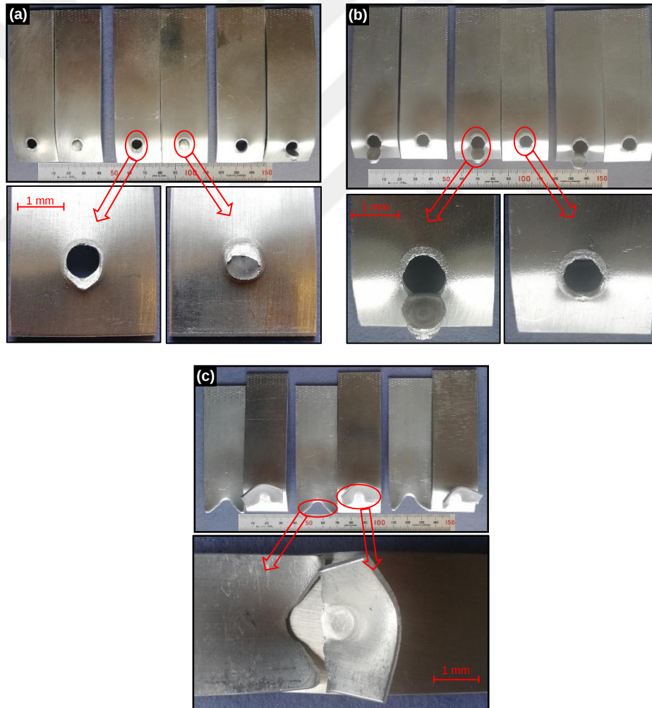
Şekil 5.11. Çekme-makaslama testi sonrası kopma görüntüleri.
