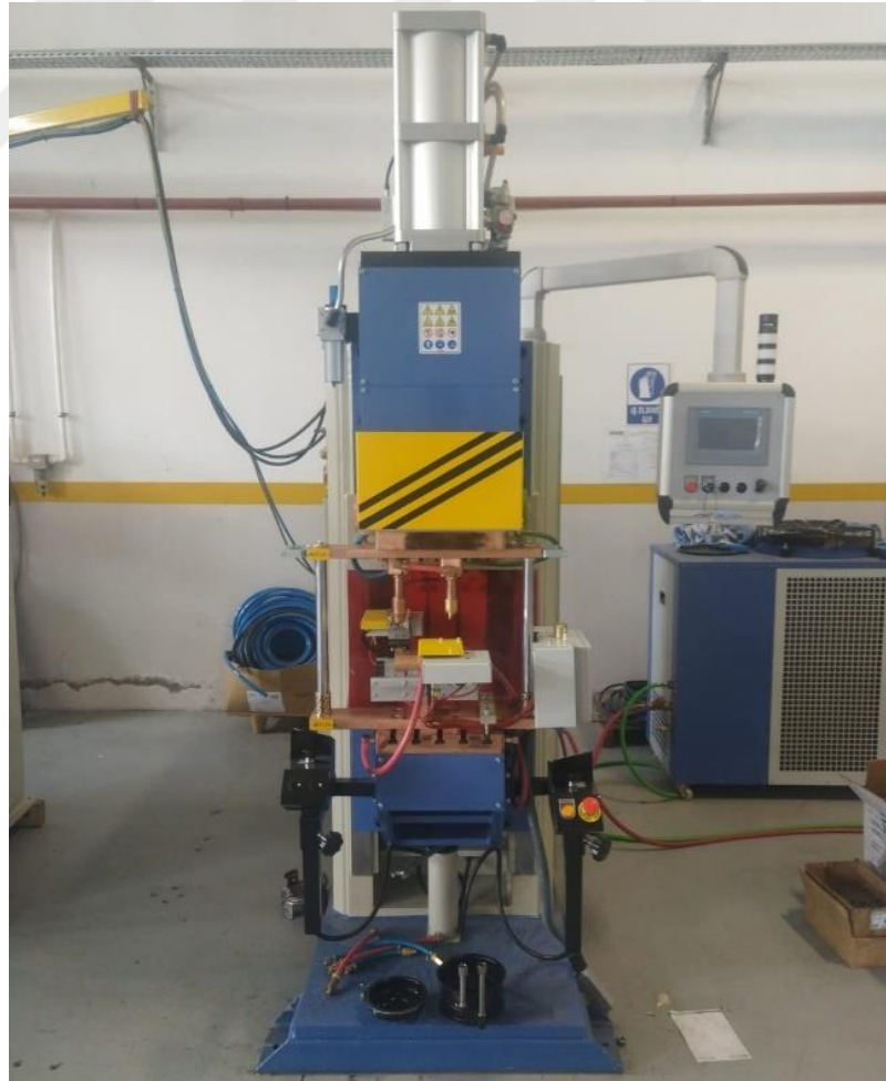
Şekil 4.2. Kaynak işlemlerini gerçekleştirdiği MFDC makine.
