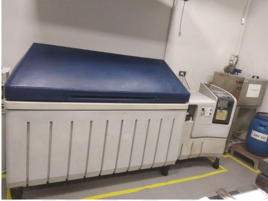
Şekil 4.15. NSS testlerinin yapıldığı cihaz.
