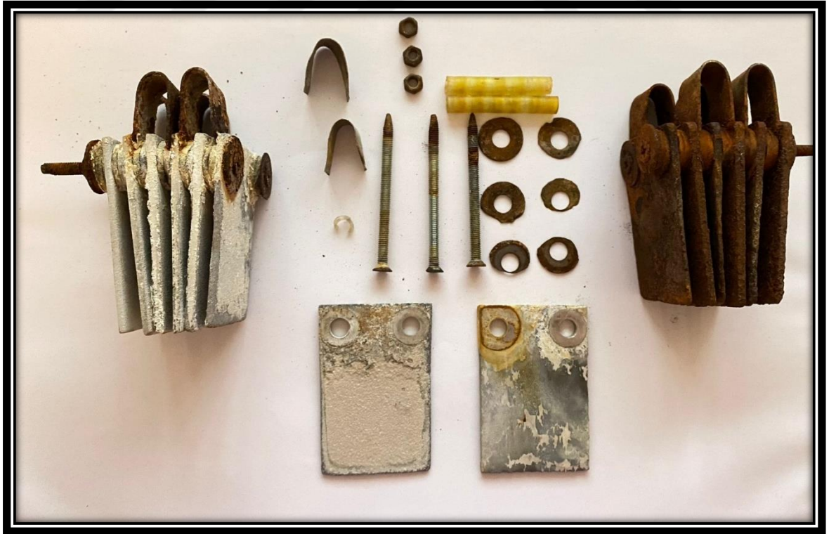
Görsel 7.2. Çalışmalar Sonucu Yıpranan Elektrot Kümeleri ve Malzemeleri
