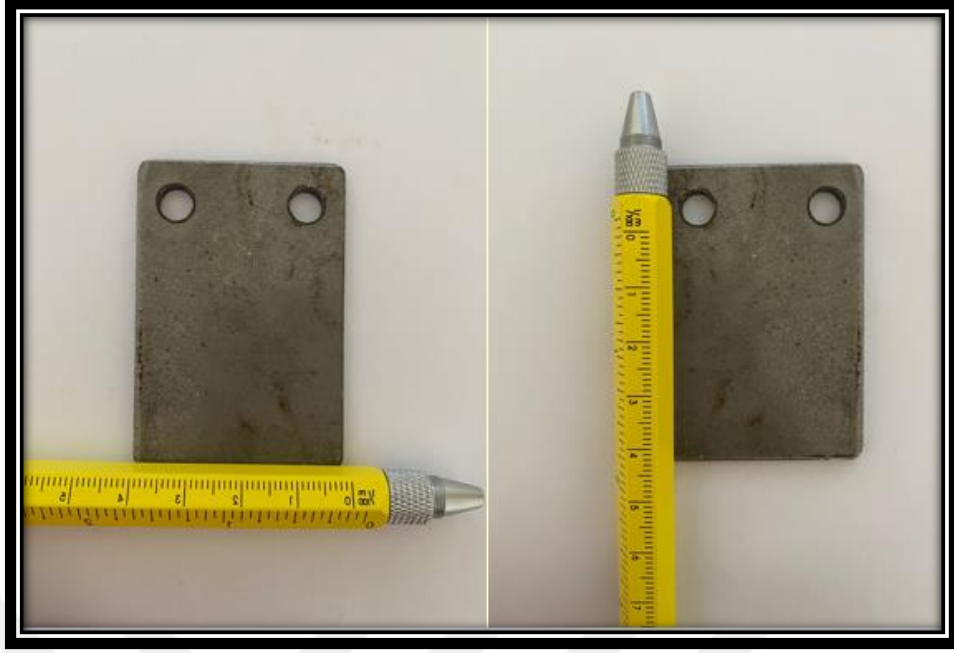
Görsel 5.1. Kullanılan Elektrot Plakasının Etkin Alan Ölçüleri
