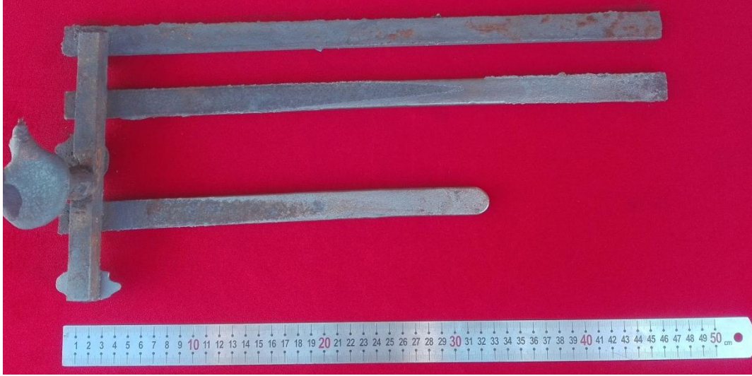
Şekil 31. 1500 °C sıcaklık, %80 metalürji kalitesi, 10 s dolum hızı şartlarındaki döküm
