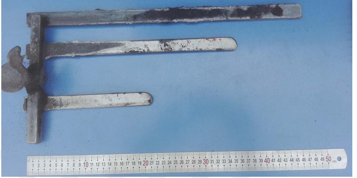
Şekil 19. Döküm kesit kanallarındaki sıvı metal ilerleme mesafesinin ölçümünün gösterilmesi
