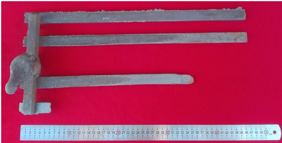
Şekil 28. 1425 °C sıcaklık, %80 metalürji kalitesi, 5 s dolum hızı şartlarındaki döküm
