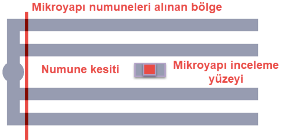
Şekil 20. Mikro yapı numunesi alınan bölgelerin gösterilmesi
