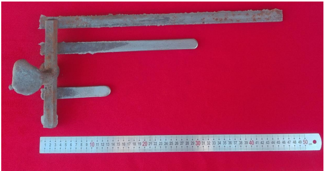
Şekil 26. 1350 °C sıcaklık, %80 metalürji kalitesi, 5 s dolum hızı şartlarındaki döküm
