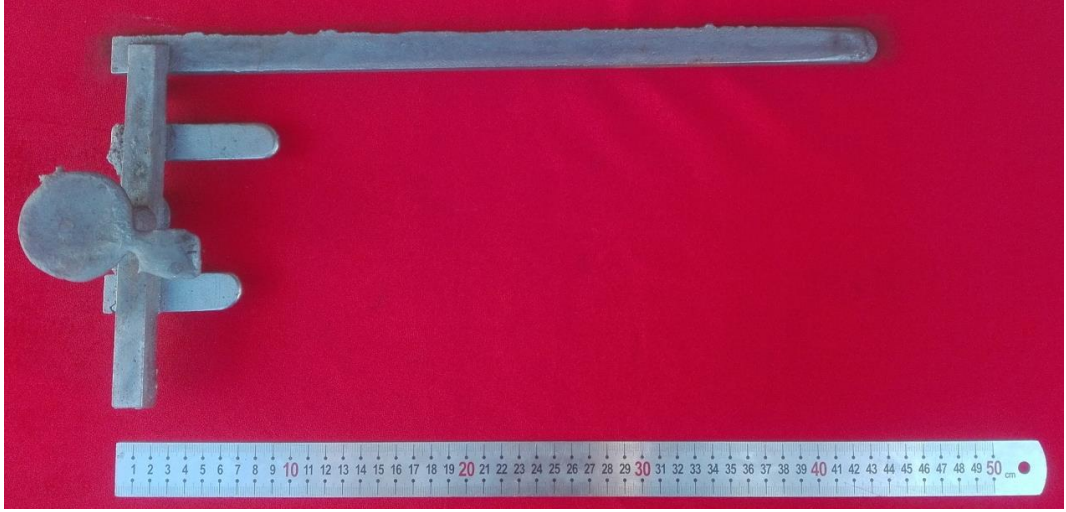
Şekil 25.1350 °C sıcaklık, %20 metalürji kalitesi, 10 s dolum hızı şartlarındaki döküm
