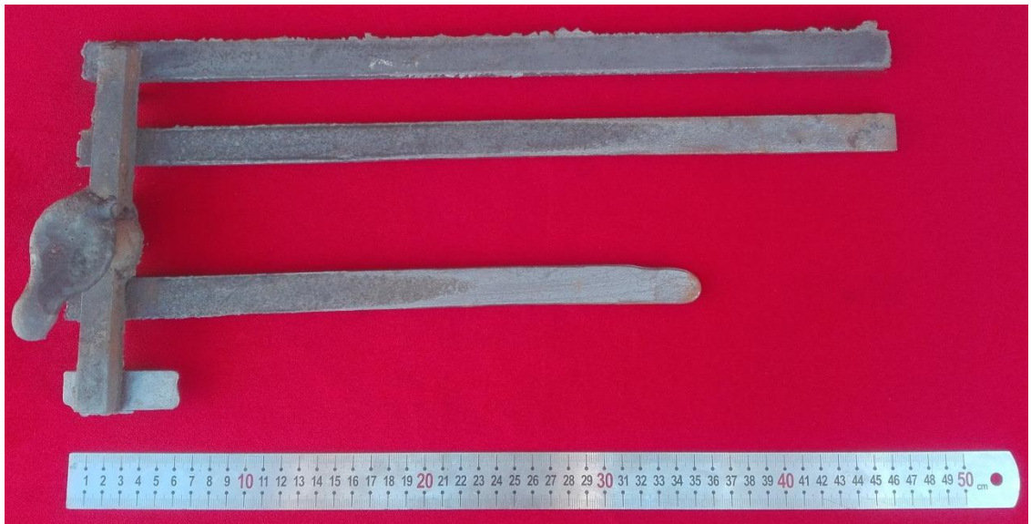
Şekil 30. 1500 °C sıcaklık, %80 metalürji kalitesi, 5 s dolum hızı şartlarındaki döküm
