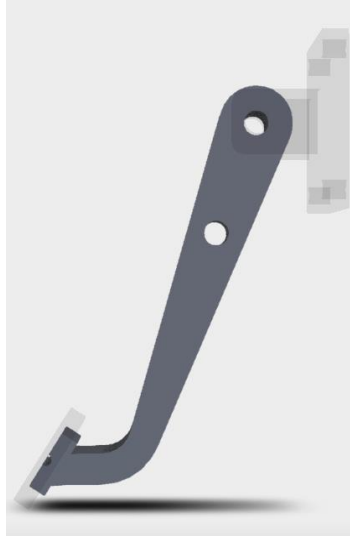
Şekil 3.7. Topoloji optimizasyon çalışması yapılacak pedal
