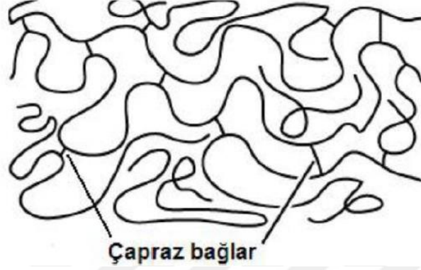
Şekil 2.6. Termoset bağ yapısı (Aran 2008)
