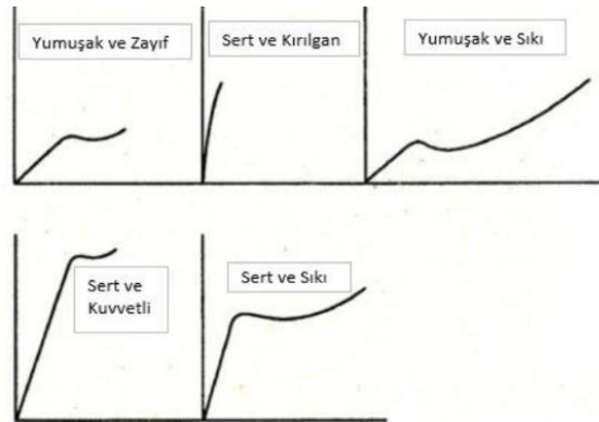
Şekil 2.9. Polimerler için tipik gerilme-uzama grafikleri (Aran 2008)
