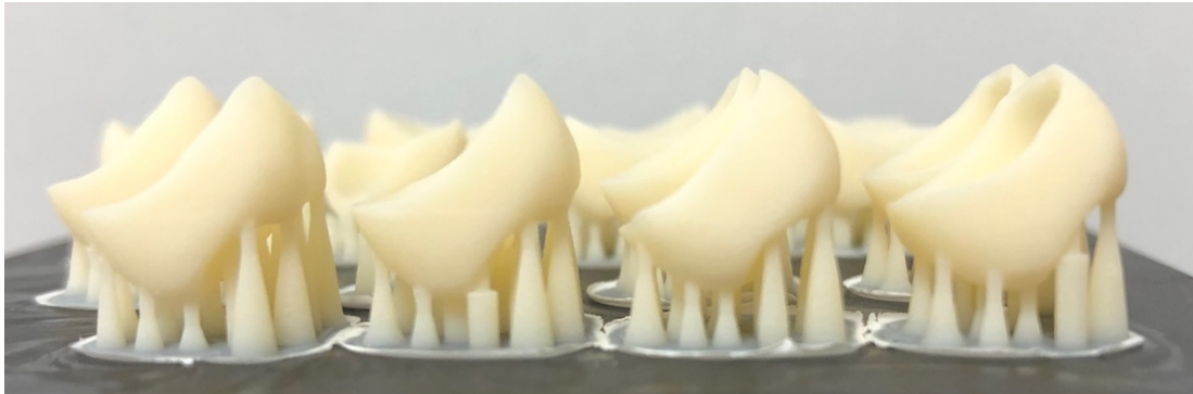
Şekil 21 - DLP 3B baskı cihazı ile diyagonal üretim açısında üretilmiş kuronların lateralden görünümü
