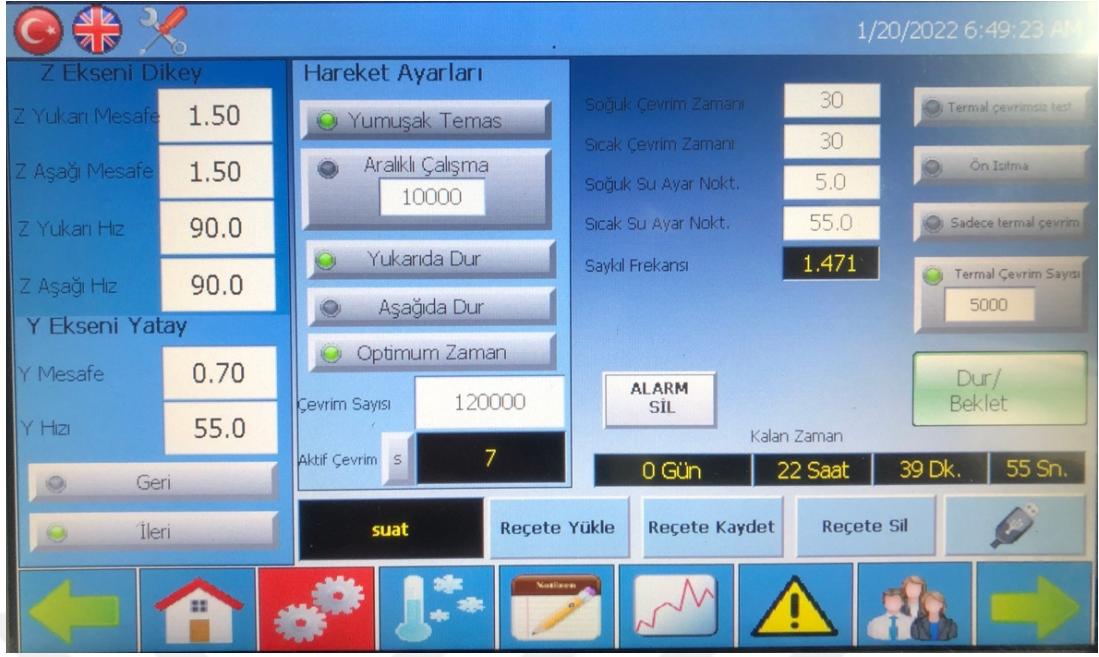
Şekil 27 - Çiğneme simülörünün ayar ve çalışmamızda kullanılan parametreleri gösteren bilgi ekranı
