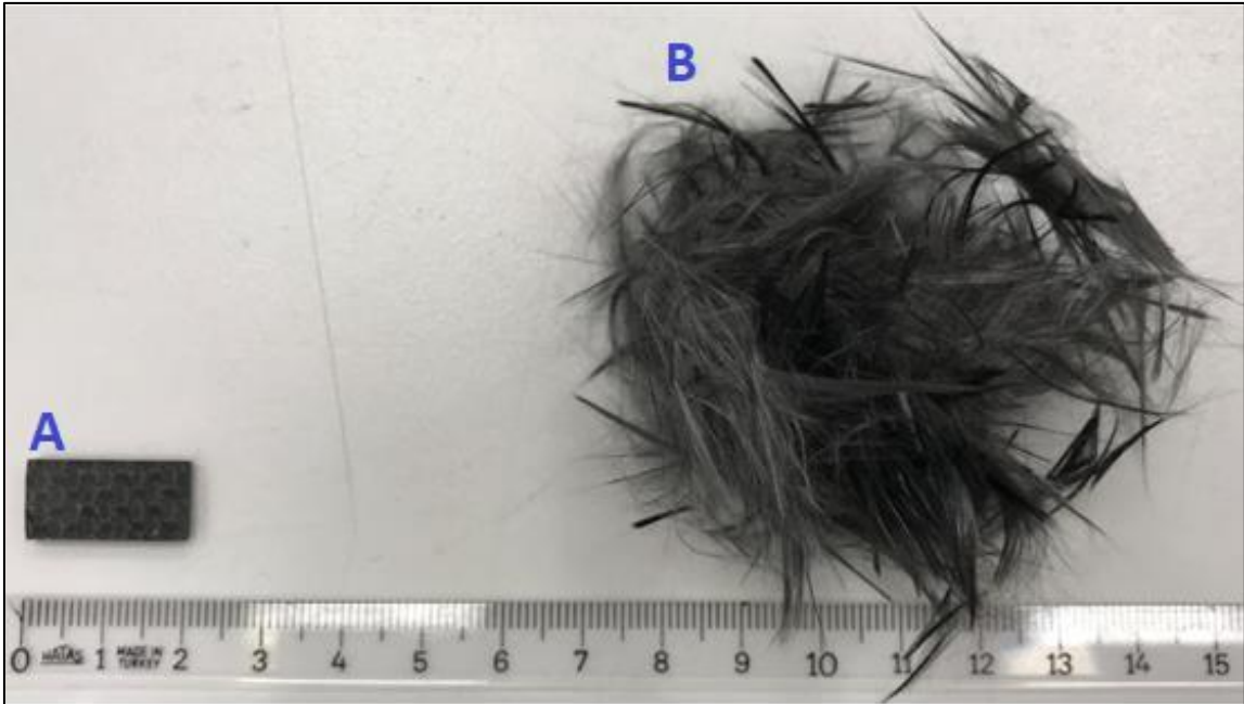
Resim 4.12. EN 2564 Deneyi Numunesi A) Deney öncesi B) Deney sonrası
