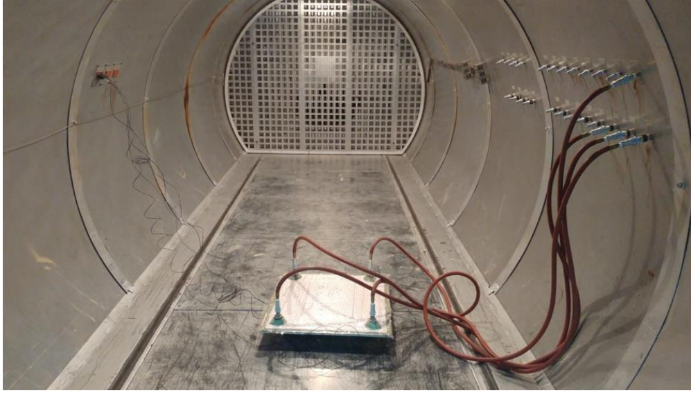
Resim 4.4. Karbon fiber prepreg malzemenin otoklav yüklemesi
