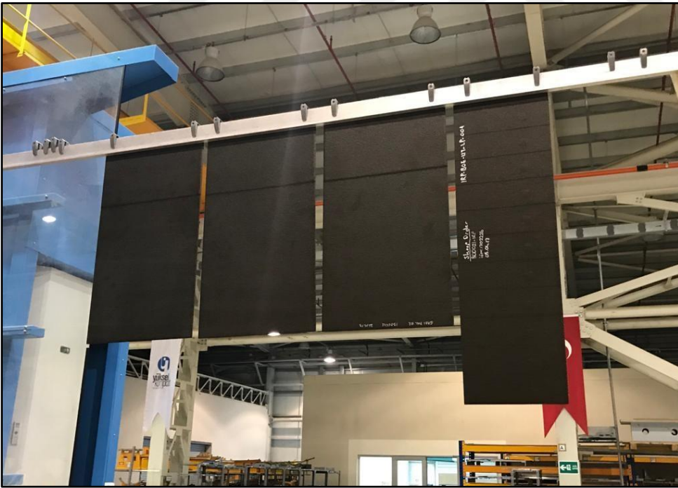
Resim 5.2. Karbon fiber takviyeli epoksi matrisli kompozitlerin tahribatsız muayenesi
