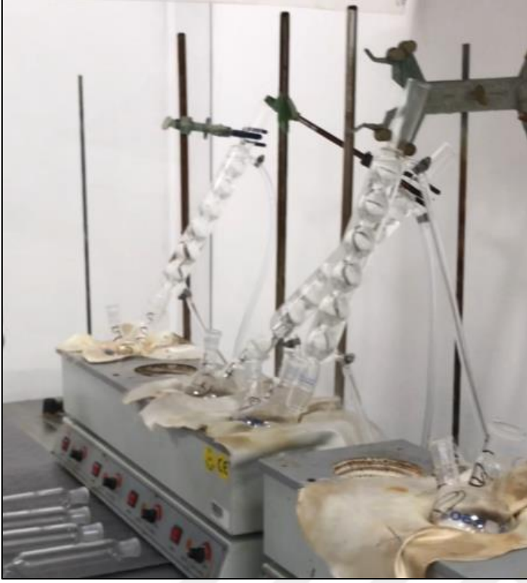
Resim 4.11. EN2564'e göre porozite deneyi düzeneđi
