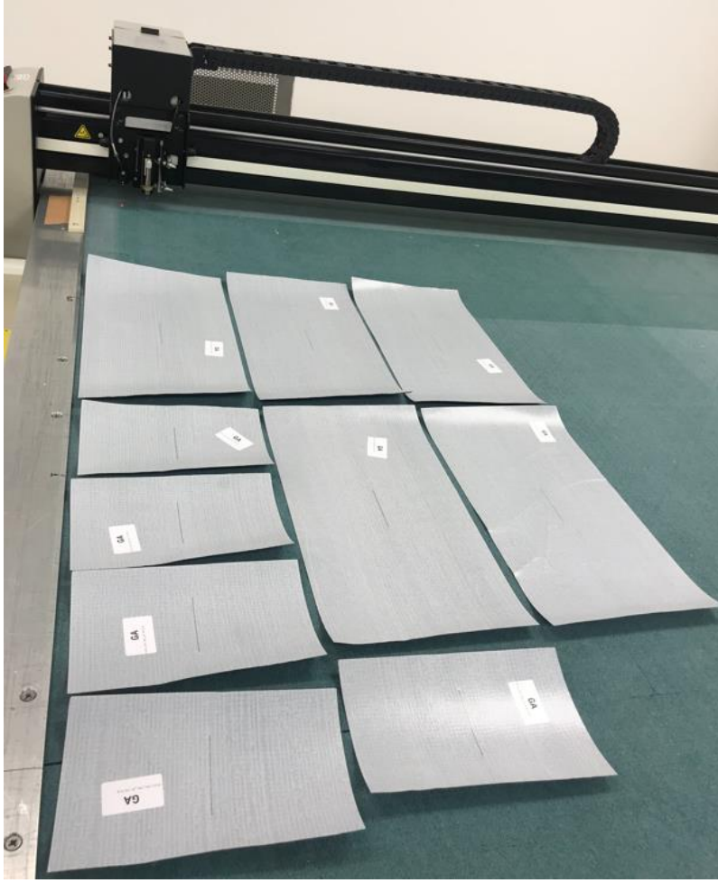
Resim 4.1. Karbon fiber prepreg kumaşın, kumaş kesme tezgahında kesilmesi
