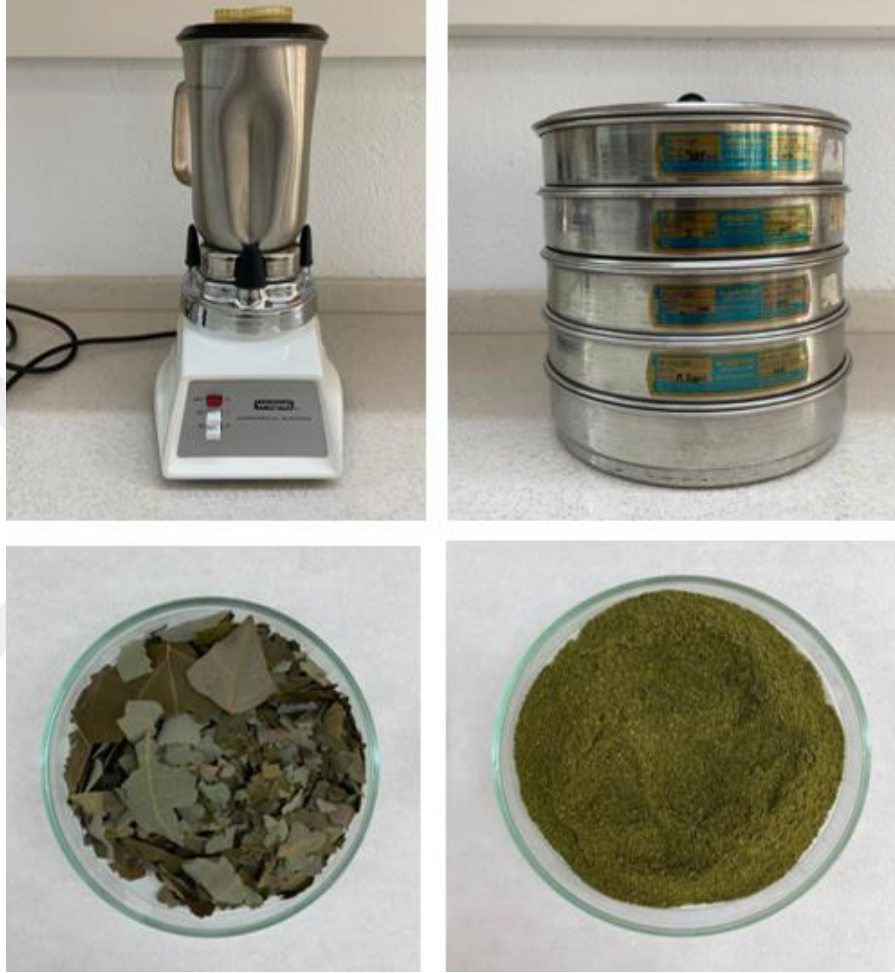
Şekil 3.4. Kurutma işlemi sonrasında elde edilen kuru yapraklar ve laboratuvar tipi bir parçalayıcı kullanılarak öğütülmesi ve elekten geçirilmesi
