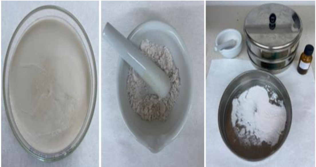
Şekil 3.11. Kurutulan kapsüllerin toz hale getirilme işlemi
