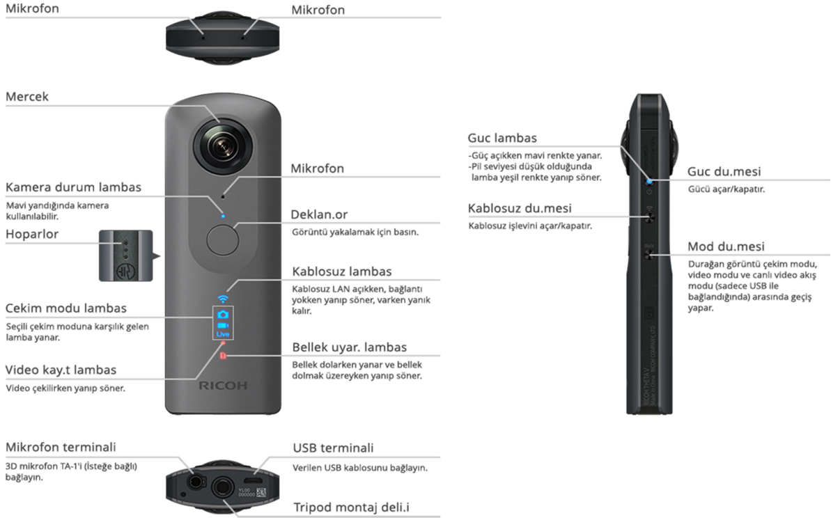
Şekil 13 Ricoh 360 derece Video Kamera Temel Bileşenleri
