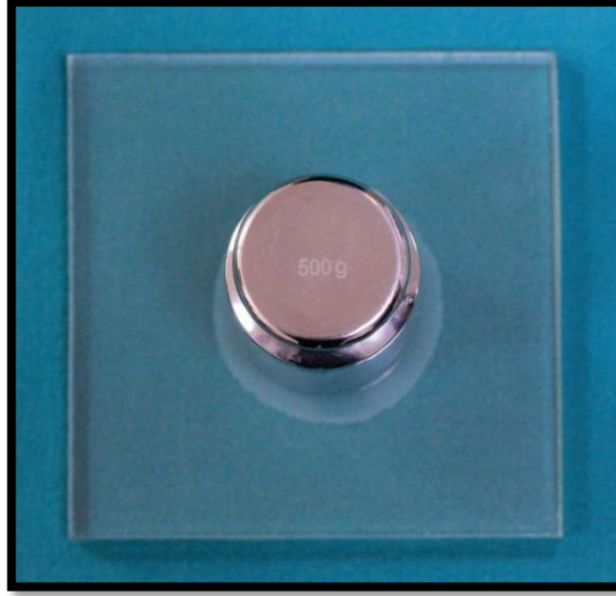
Şekil 4. İki cam tabaka üzerine 500 gr ağırlık yerleştirilmesi
