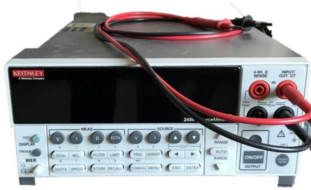
Şekil 5.11: Çalışmada elektriksel iletkenlik ölçümlerinde kullanılan cihaz.
