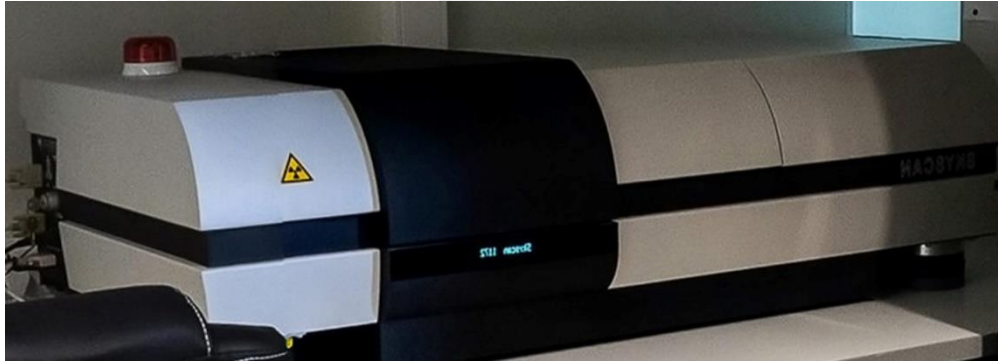
Şekil 5.10: Çalışmada kullanılan Micro-CT cihazı.
