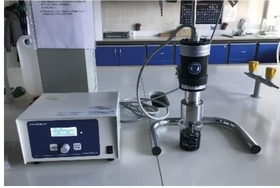
Şekil 5.2: Çalışmada uygulanan ultrasonikasyon işlemi.
