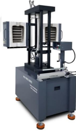
Şekil 5.4: Çalışmada kullanılan sıcak pres cihazı.
