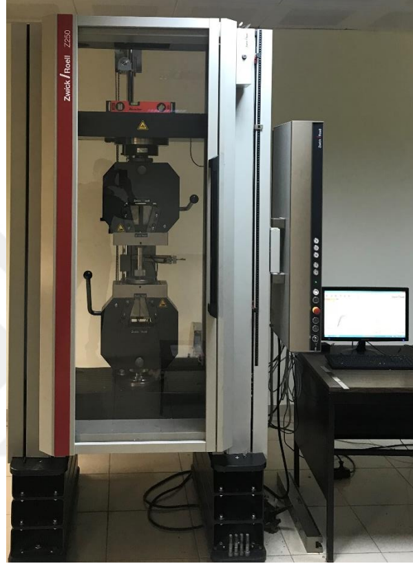
Şekil 5.14: Çalışmada kullanılan universal basma test cihazı.
