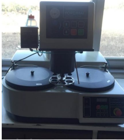
Şekil 5.5: Zimparalama ve parlatma işleminin yapıldığı cihaz.
