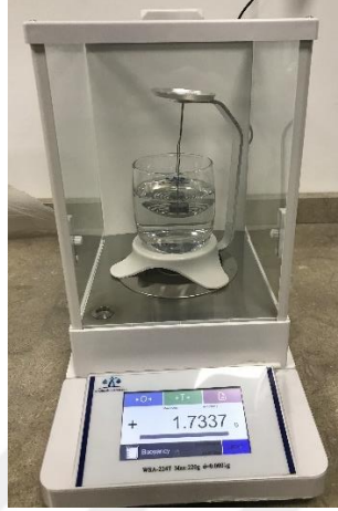
Şekil 5.6: Deneyde kullanılan Arşimet terazisi.
