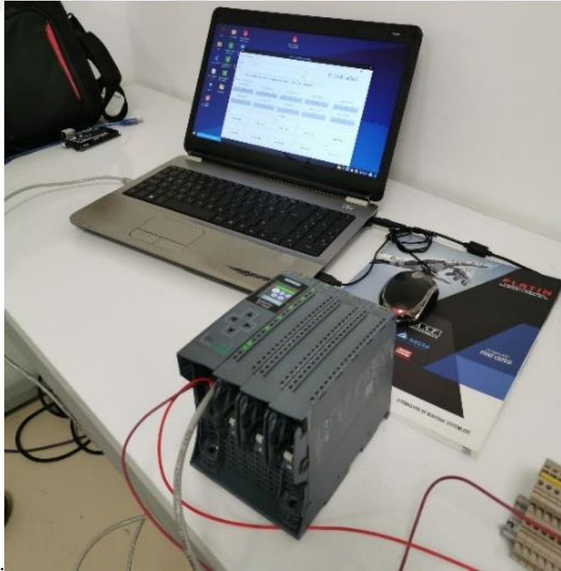
Şekil 2.29. Test yazılımını Siemens S7/1500 PLC test kurulumu
