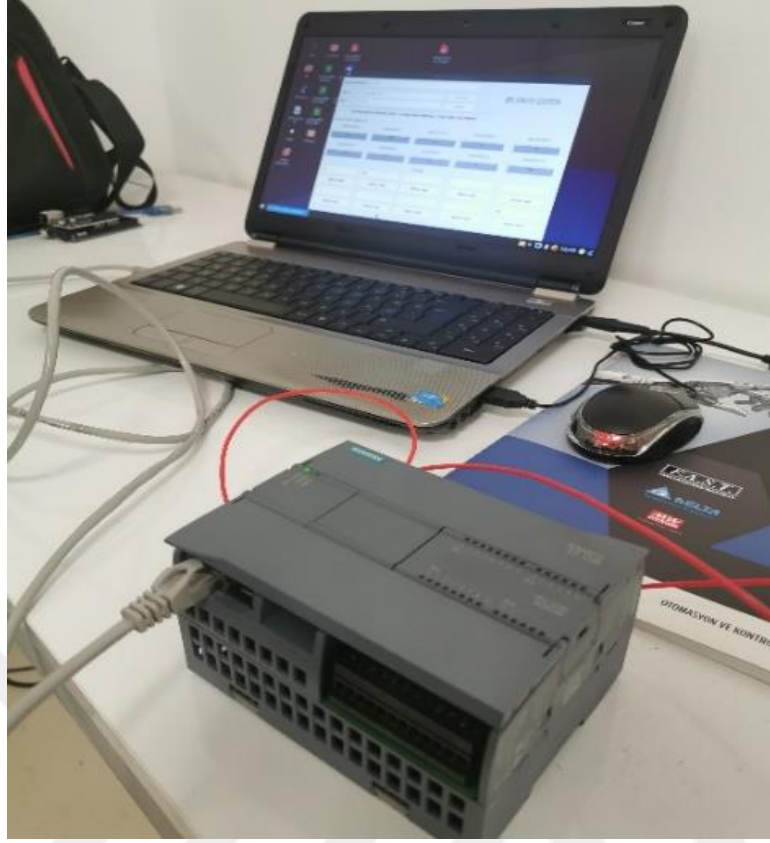
Şekil 2.28. Test yazılımını Siemens S7/1200 PLC test kurulumu
