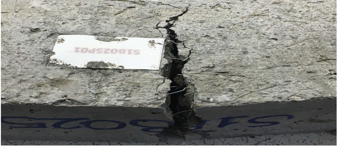
Şekil 27. S1B025P01 kodlu numunede görülen çelik donatının köprüleme davranışı
