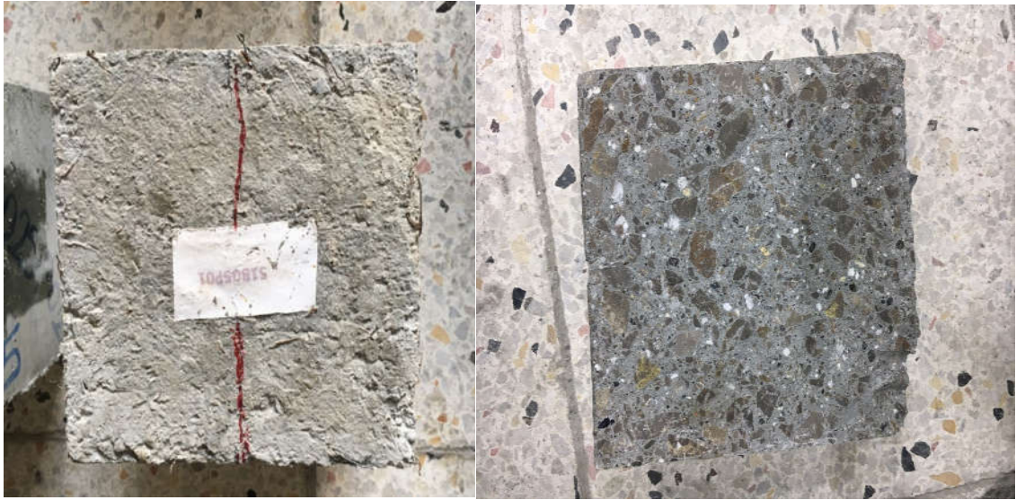
Şekil 30. Deney sonrası numunelerde çatlak oluşumu (solda) ve kırılma yüzeyinin görüntüsü
