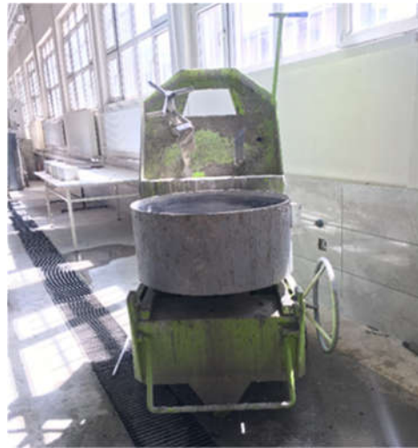
Şekil 10. Beton üretiminde kullanılan mikser
