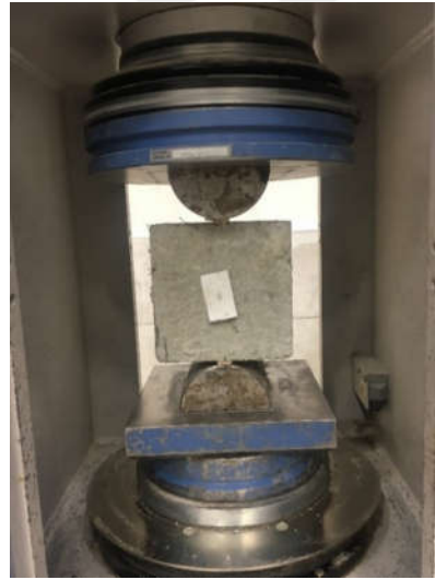
Şekil 18. Yarmada çekem deney düzeneği (solda) ve deney anından bir görüntü
