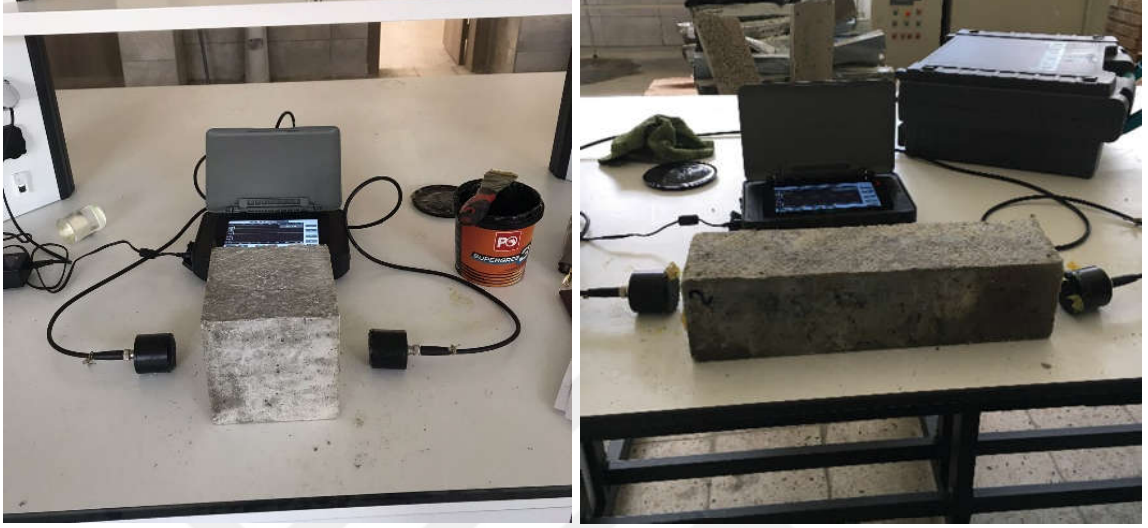
Şekil 15. Küp (solda) ve prizmatik (sağda) numunelerin UPV ölçüm görüntüleri
