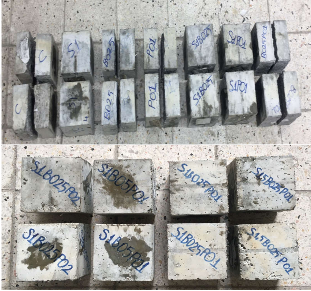
Şekil 29. Tüm numunelerin yarmada çekme dayanımı sonucu kırılma biçimleri
