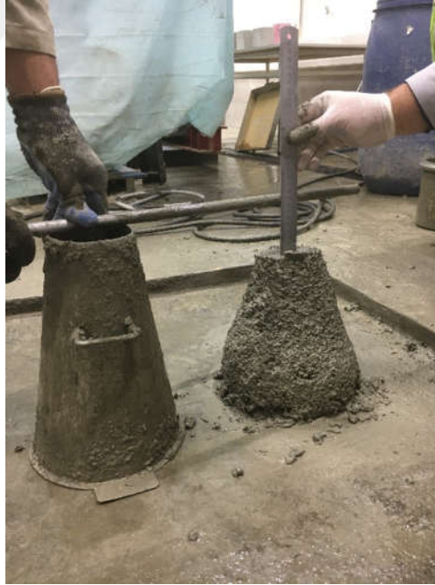
Şekil 11. Taze betonda çökme miktarı ölçümü
