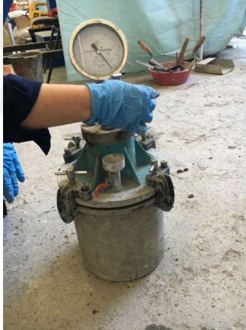
Şekil 12. Hava ölçer (airmeter) cihazı ve deney anından bir görüntü
