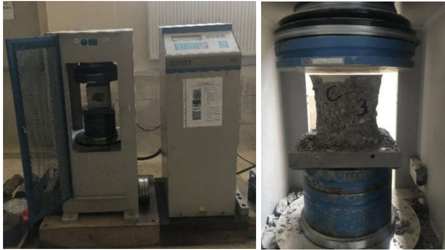
Şekil 16. Beton presi (solda) ve deney anından bir görüntü
