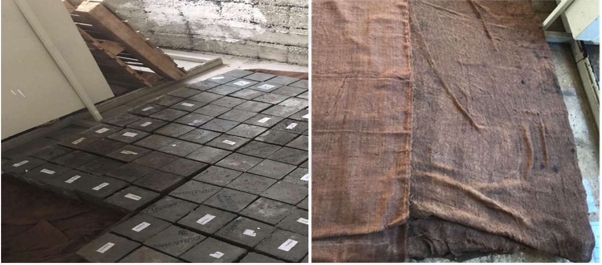
Şekil 14. Telis bezi örtülerek nem kürüne tabii tutulan numuneler
