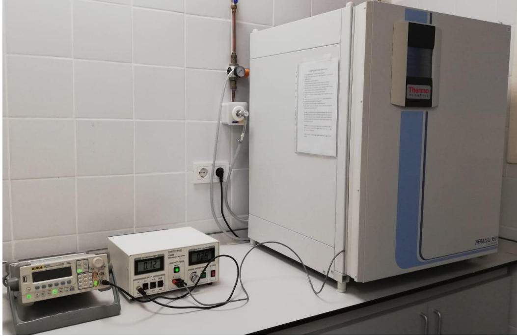
Şekil 2.7. Düşük frekanslı- darbeli elektromanyetik alan maruziyeti oluşturmak için kurulmuş sistem
