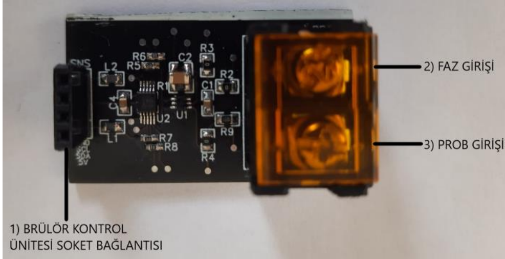
Şekil 5.15. Alev Sensörü Tanımlamaları
