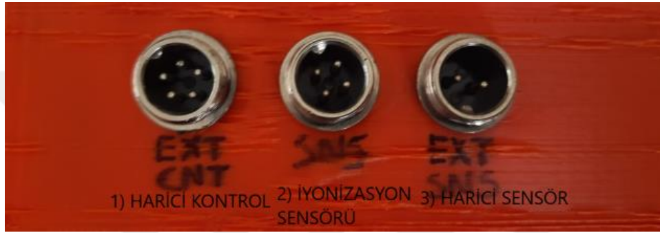
Şekil 5.13. Brülör Kontrol Ünitesi Soket Tanımlamaları
