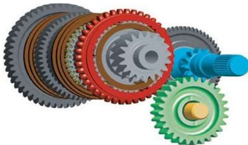
Şekil 2. 8. Geri Vites Mekanizması(Oudrnický ve Tomeh 2017)
