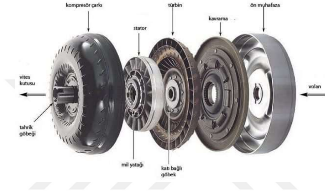
Şekil 2. 9. Tork Konvertörü Bileşenleri(Er 2019)
