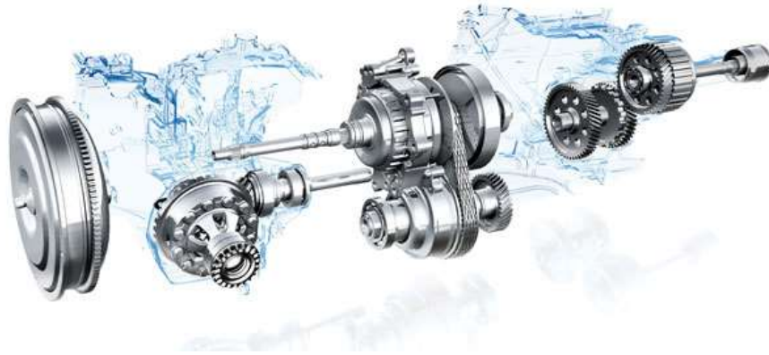
Şekil 2. 13. CVT Şanzıman Sistem İç Yapısı(Pepper 2014)
