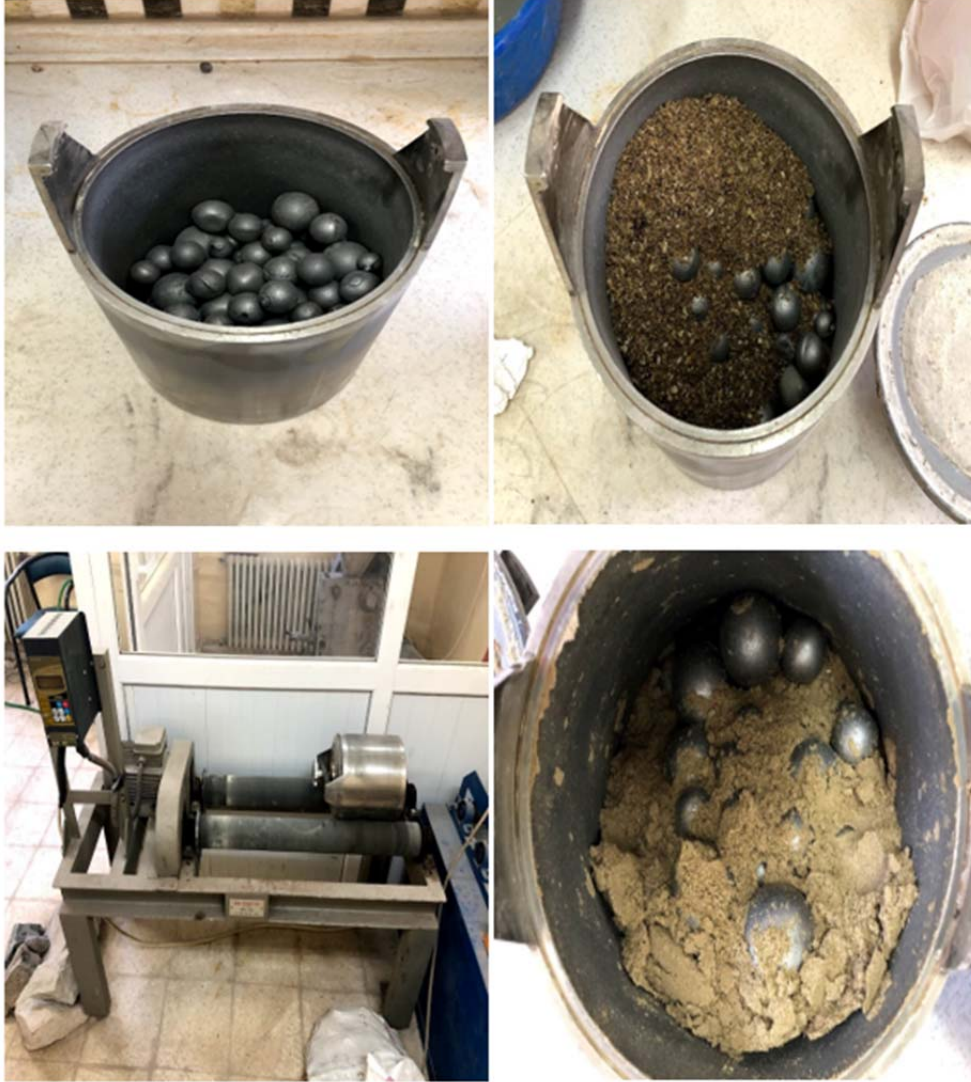
Şekil 3.2. Bilyalı değirmen yardımı ile kemik tozunun elde edilme aşamaları
