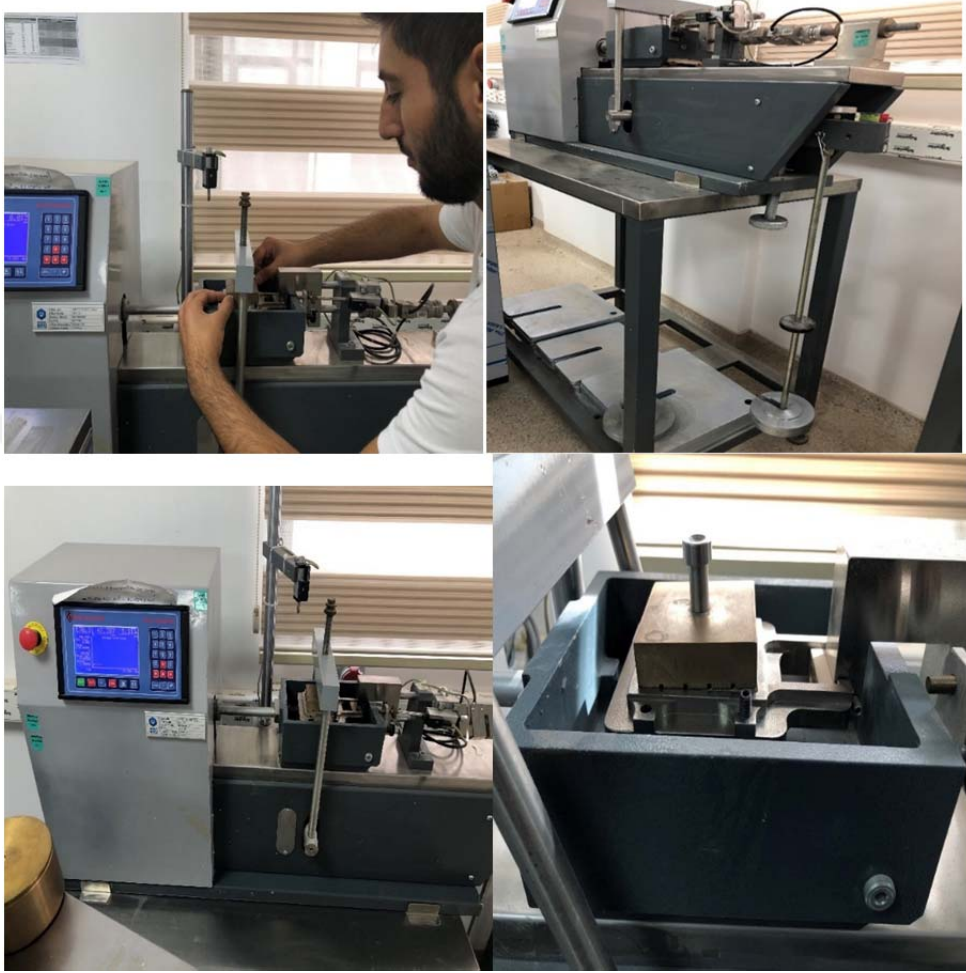
Şekil 3.9. Kesme kutusu deney aşamaları
