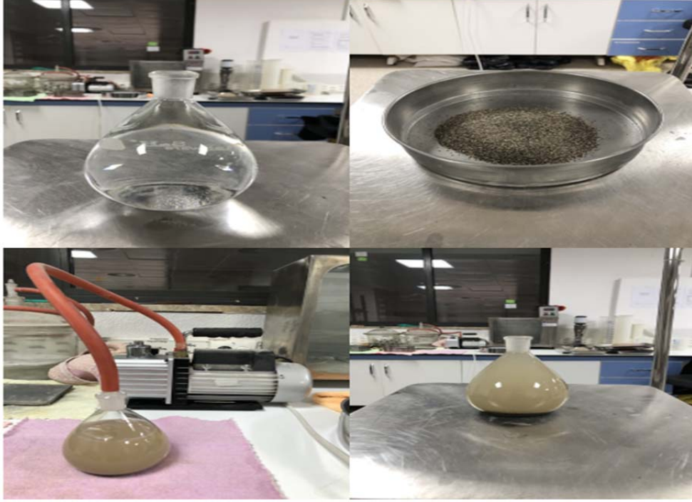
Şekil 3.5. Piknometre deney aşamaları
