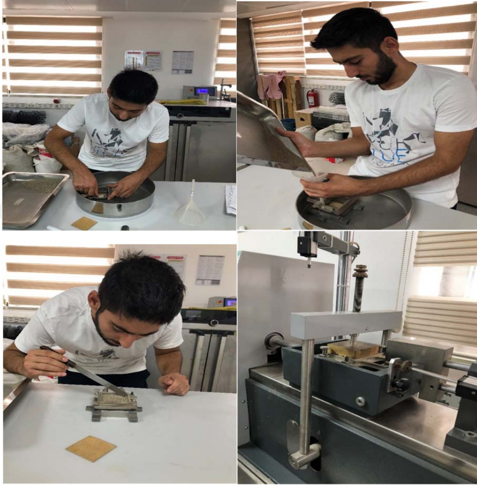
Şekil 3.8. Kesme kutusu deney öncesi aşamaları
