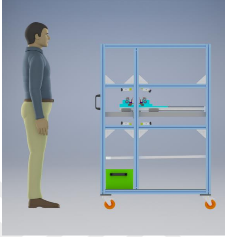
Şekil 3.30. Sprey soğutma sistemi tasarımı-1
