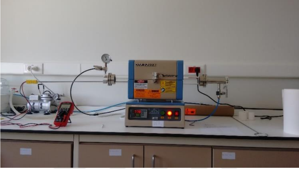
Şekil 3.2. Selenürleme işleminin gerçekleştirildiği MTI (OTF-1200X) marka tüp fırının fotoğrafı
