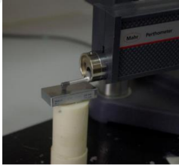
Şekil 3.8. Cihazın kalibrasyon plakası ile kalibre edilmesi
