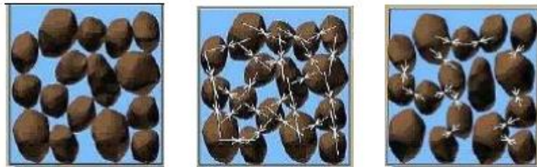
Şekil 3.1. Zemini oluşturan tanelerin statik ve dinamik ortamda birbirlerine göre durumu
