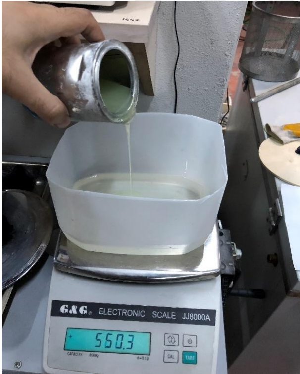
Şekil 4.6 Epoksinin hazırlanması ve tatbiki.
