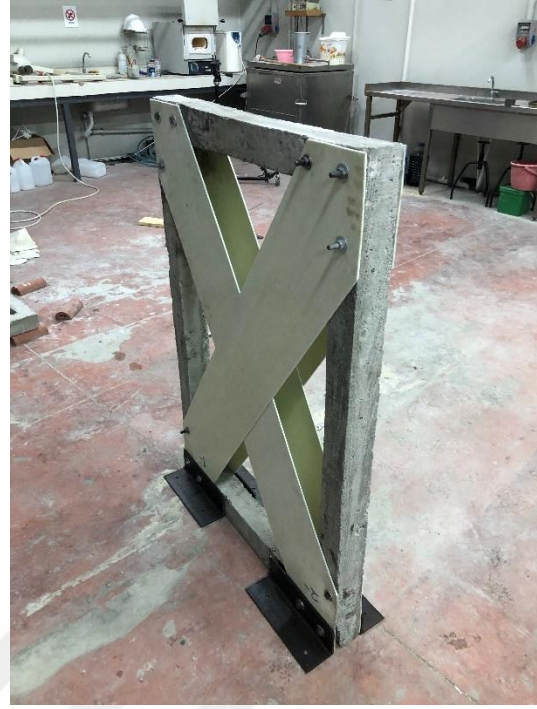
Şekil 4.8 Mesnetleri tatbik edilmiş ve teste hazır çerçeveler.
