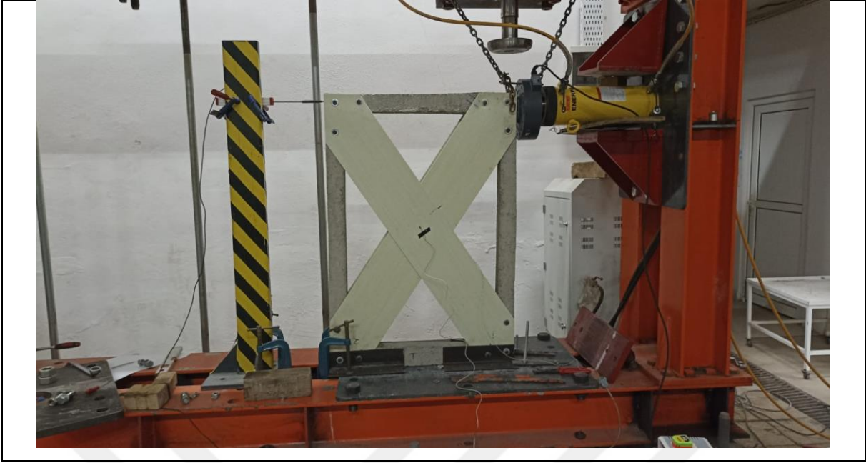
Şekil 4.65 Güçlendirilmiş betonarme çerçeve statik itme analizi öncesi
