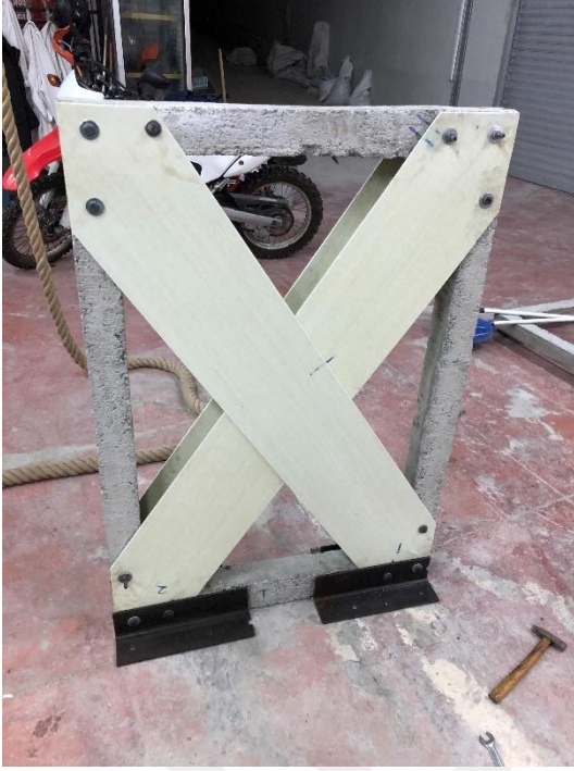
Şekil 4.8 Mesnetleri tatbik edilmiş ve teste hazır çerçeveler.
