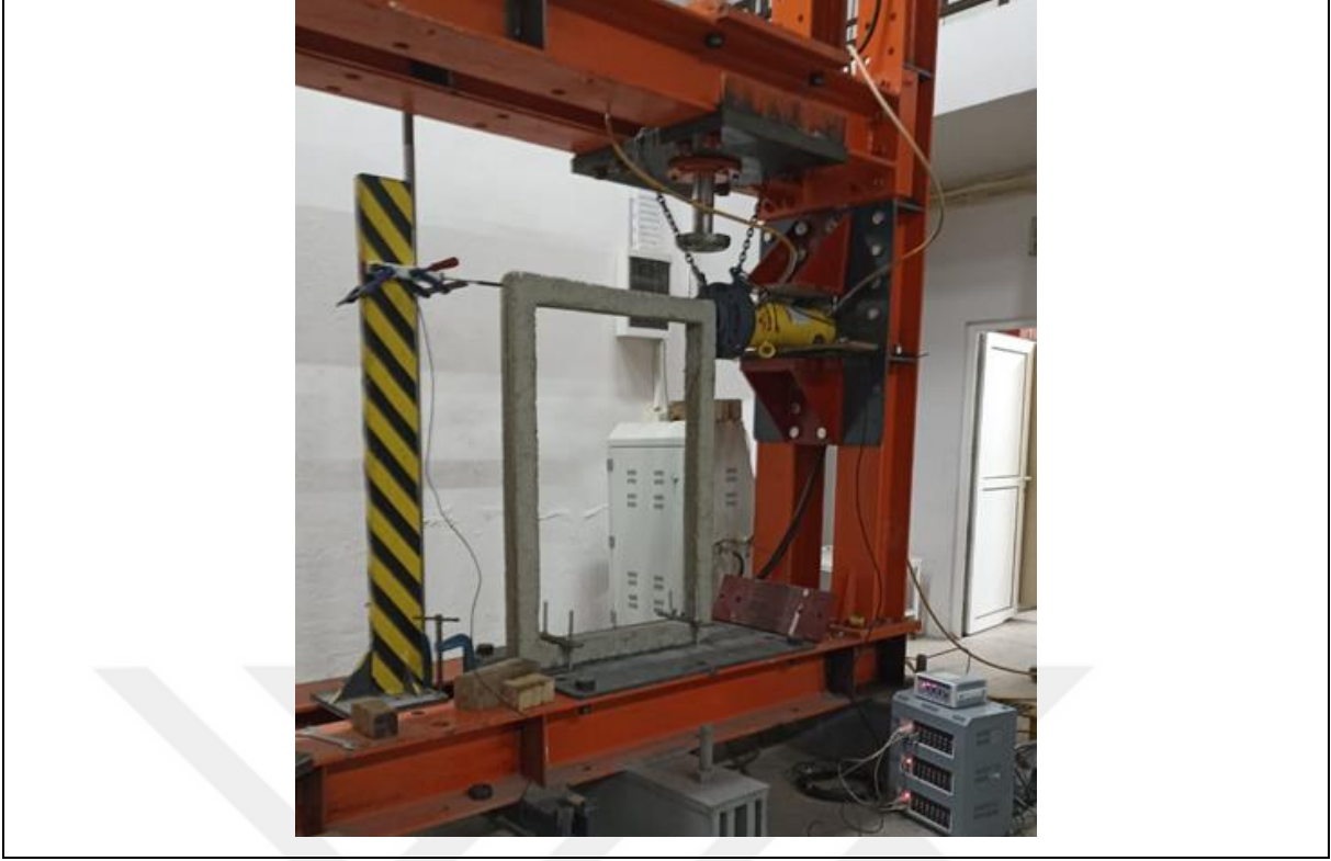
Şekil 4.63 Referans betonarme çerçeve statik itme analizi öncesi
