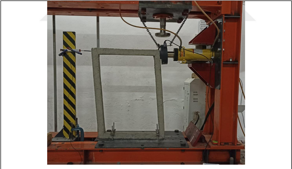
Şekil 4.64 Referans betonarme çerçeve statik itme analizi sonrası
