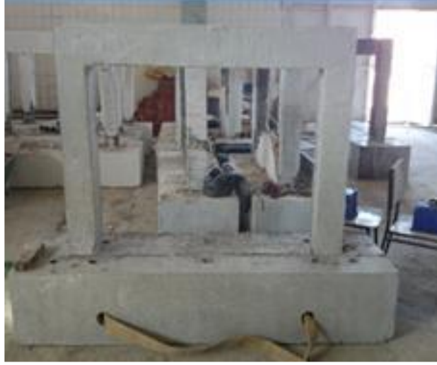
Şekil 3.2 Referans olarak seçilmiş betonarme çerçeve model.
