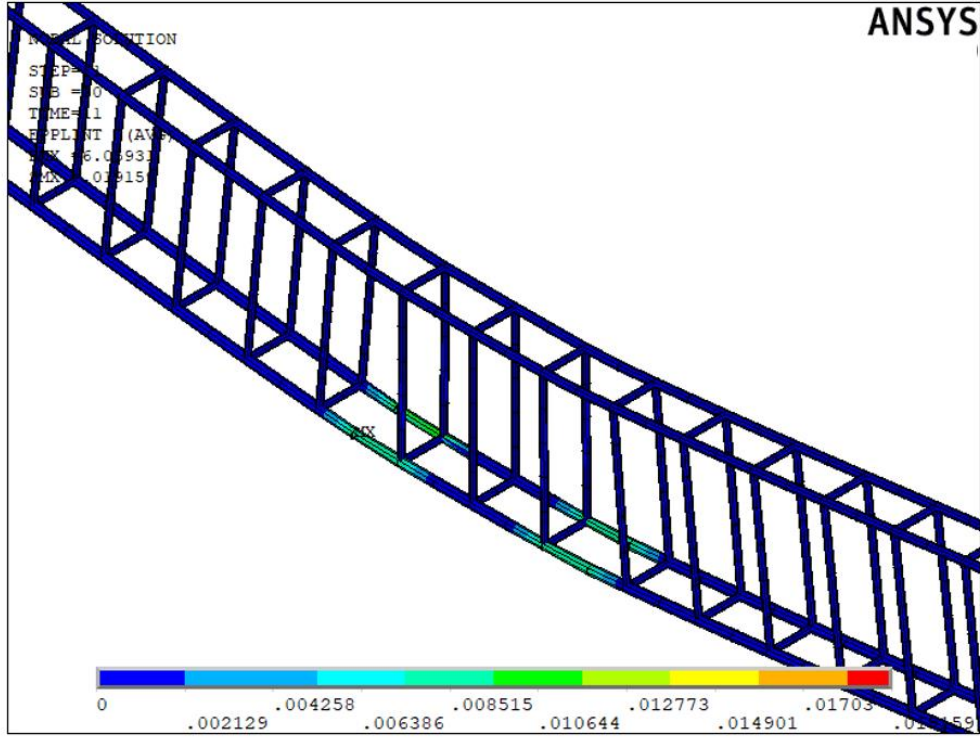
Şekil 3.40 Donatılarda meydana gelen plastik deformasyon.
