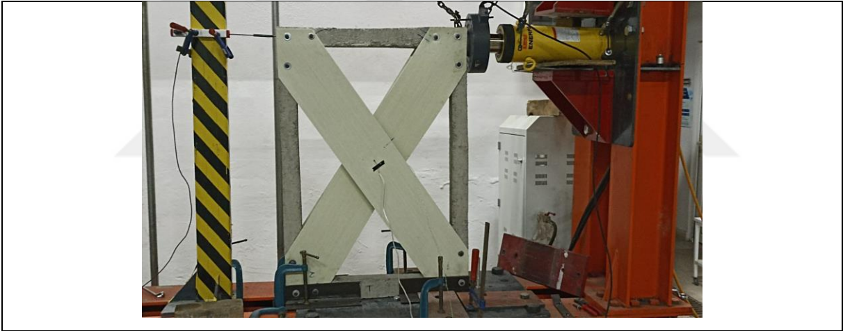
Şekil 4.66 Güçlendirilmiş betonarme çerçeve statik itme analizi sonrası
