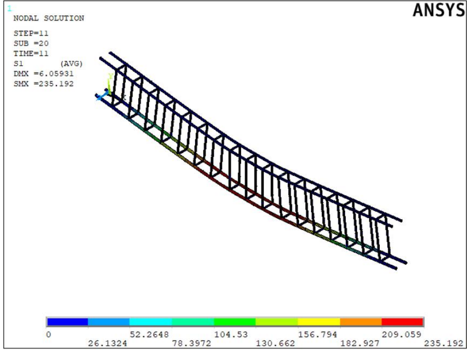
Şekil 3.38 Donatılarda meydana gelen birincil asal gerilmeler.
