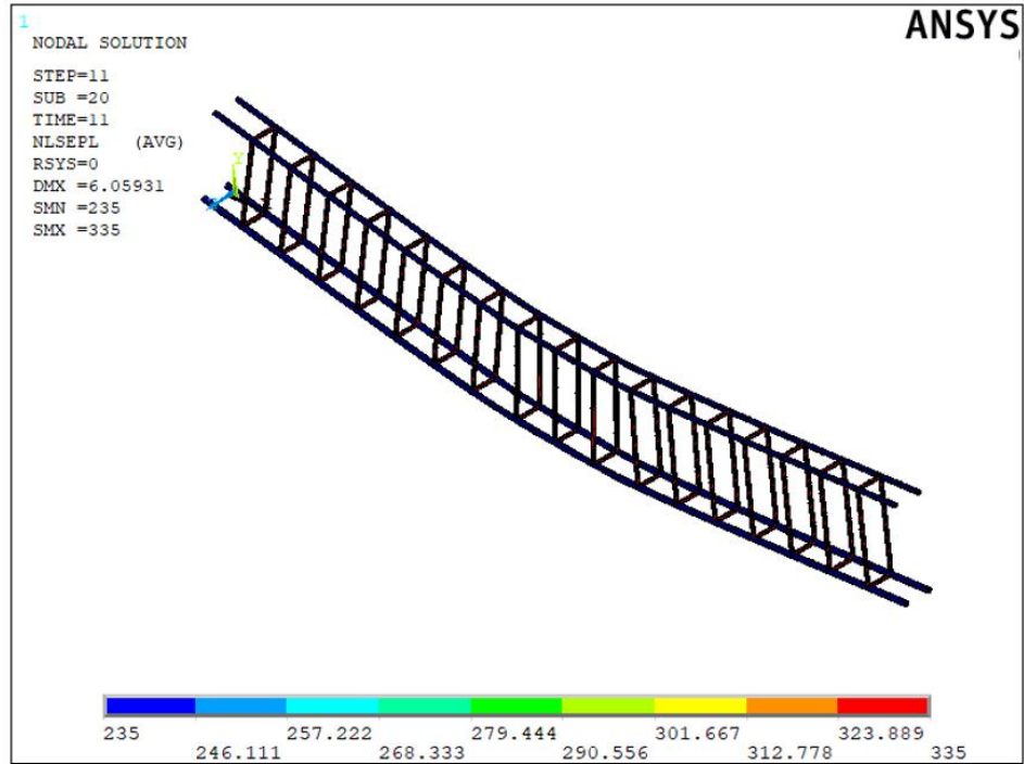
Şekil 3.39 Donatılarda meydana gelen plastik eşdeğer stres.
