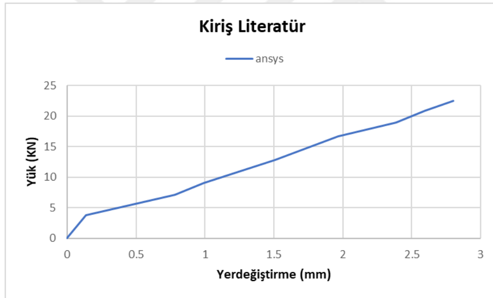
Şekil 3.29 Betonarme kirişin orta noktasındaki sehimin yük altında davranış verilmektedir (Zhang vd. 2013).
