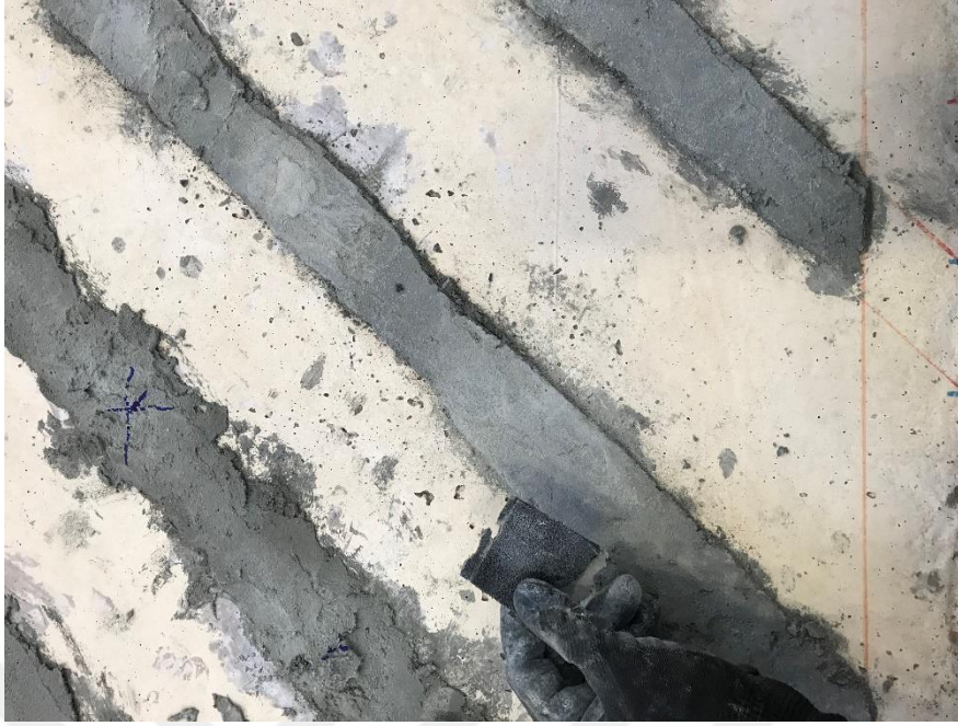
Şekil 3.13. Strain-Gauge yapıştırılacak yüzeylerin hazırlanması
