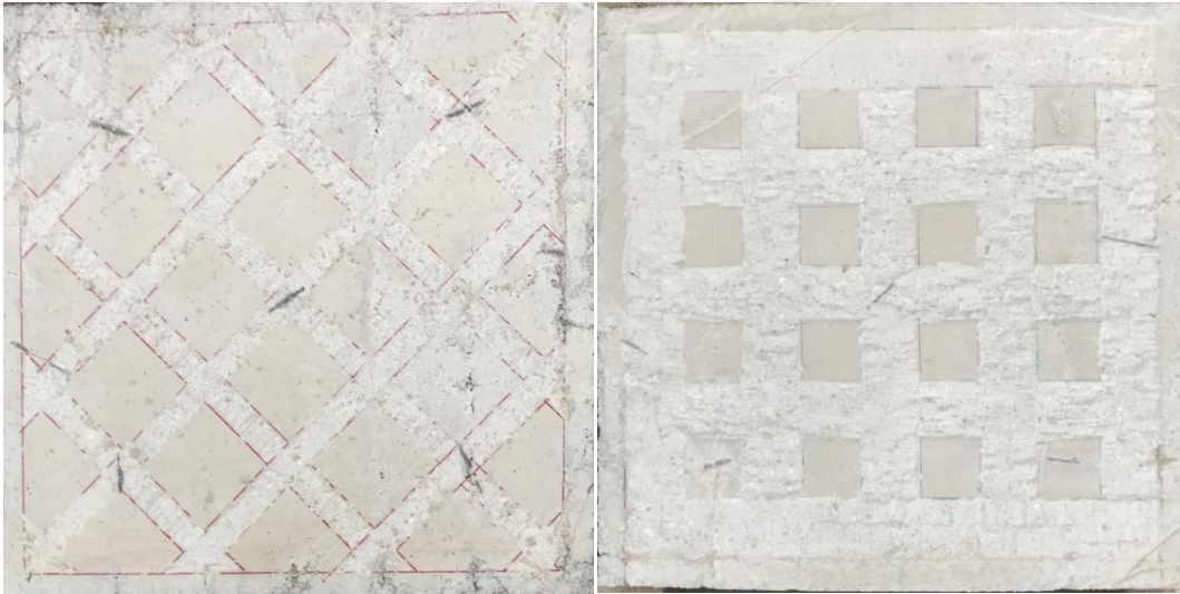
Şekil 4.9. Pürüzlendirme işlemi a) 50mm'lik şeritlerin yerleşeceği alanların pürüzlendirilmesi, b) 100mm'lik şeritlerin yerleşeceği alanların pürüzlendirilmesi
