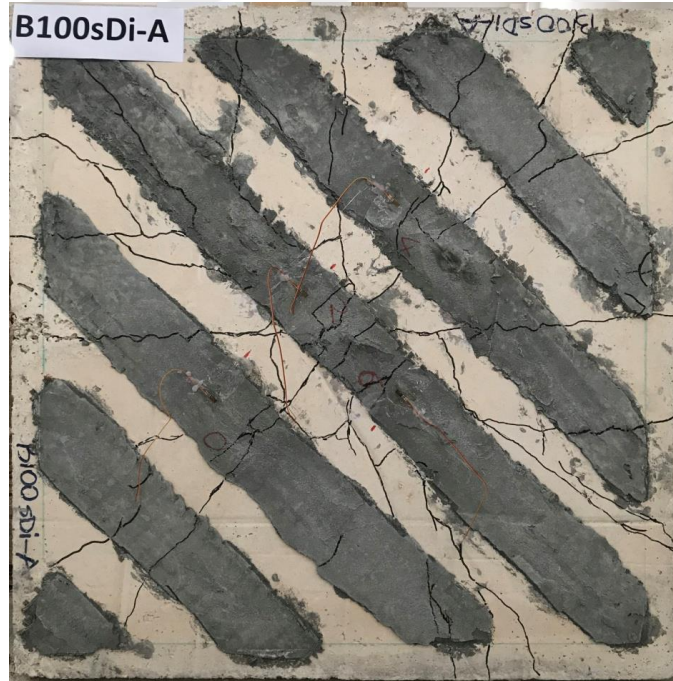
Şekil 5.45. B100sDi-A plağında meydana gelen çatlak dağılımı
