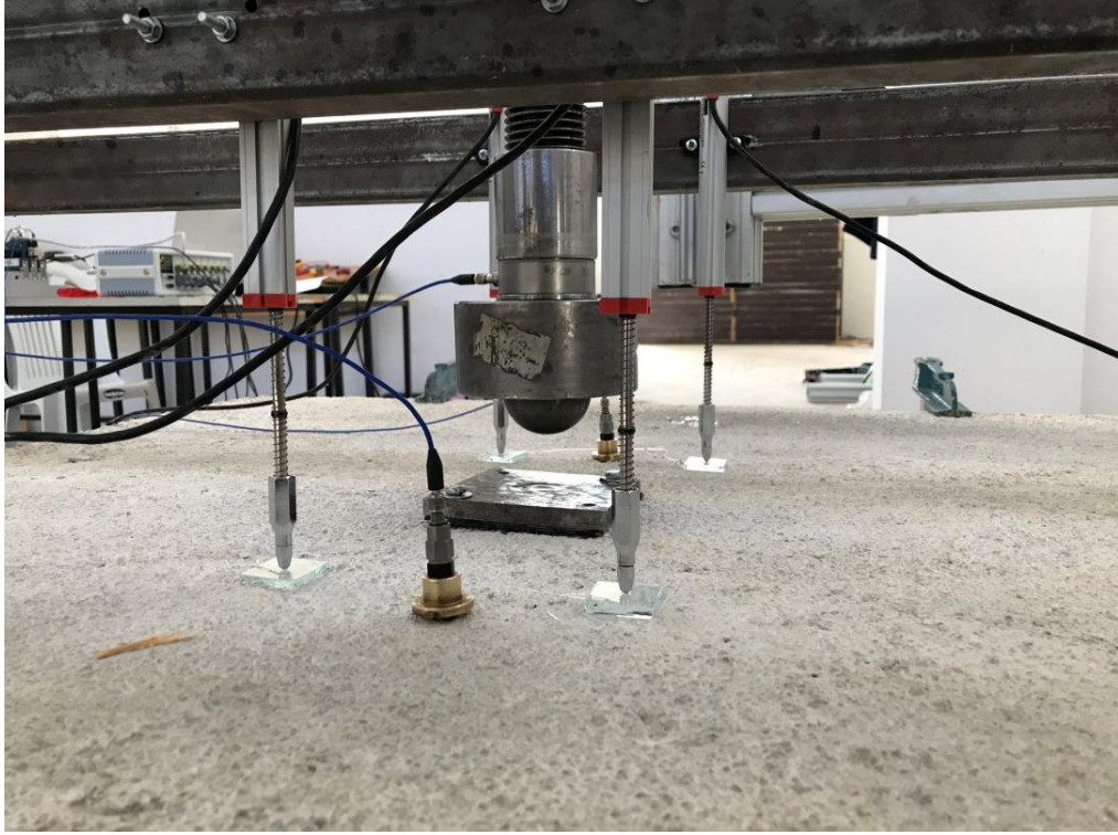
Şekil 3.9. Darbe yük hücresi montajı
