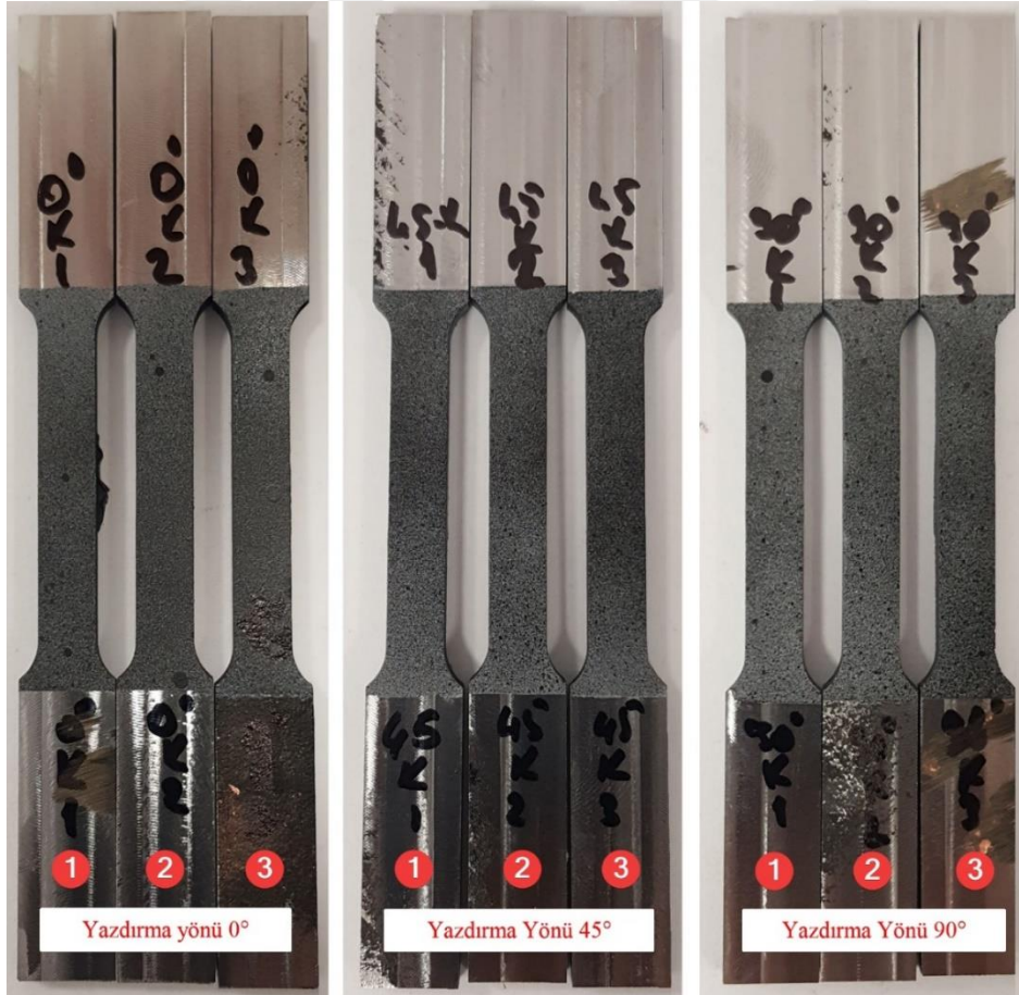
Şekil 3.14. Kullanıma hazır hale gelen kaynaklı çekme testi numuneleri
