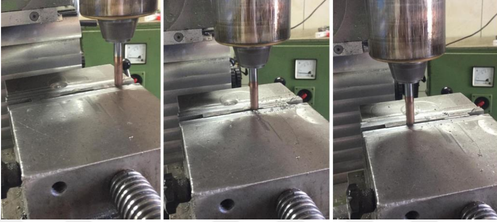
Şekil 3.13. Kaynaklı çekme testi numuneleri üzerinde frezeleme operasyonu
