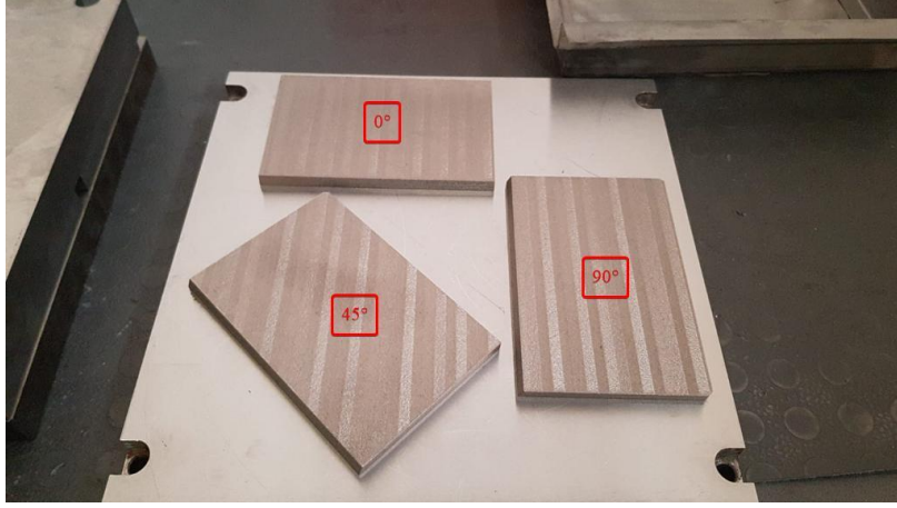
Şekil 3.7. Kaynaklı numuneler için yazdırılan plakalar
