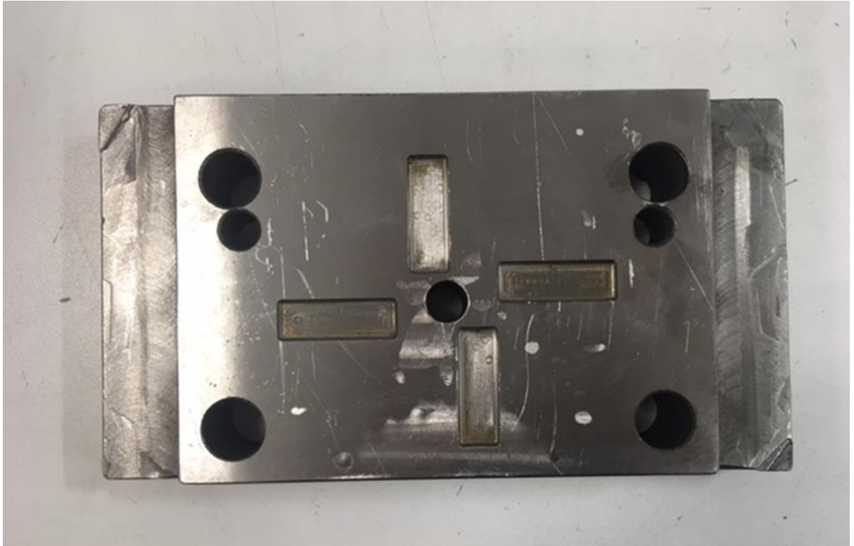
Resim 6.1. Plastik Enjeksiyon Kalıbı Dişi Plakası
